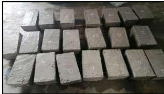
Figura 35: Desencofrado de ladrillos
