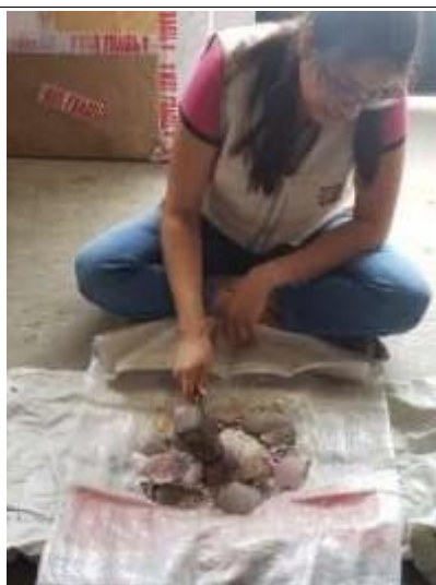
Figura 25: Trituración de las valvas manualmente
