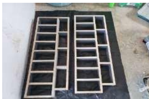
Figura 30: Elaboración de moldes para los Eco ladrillo
