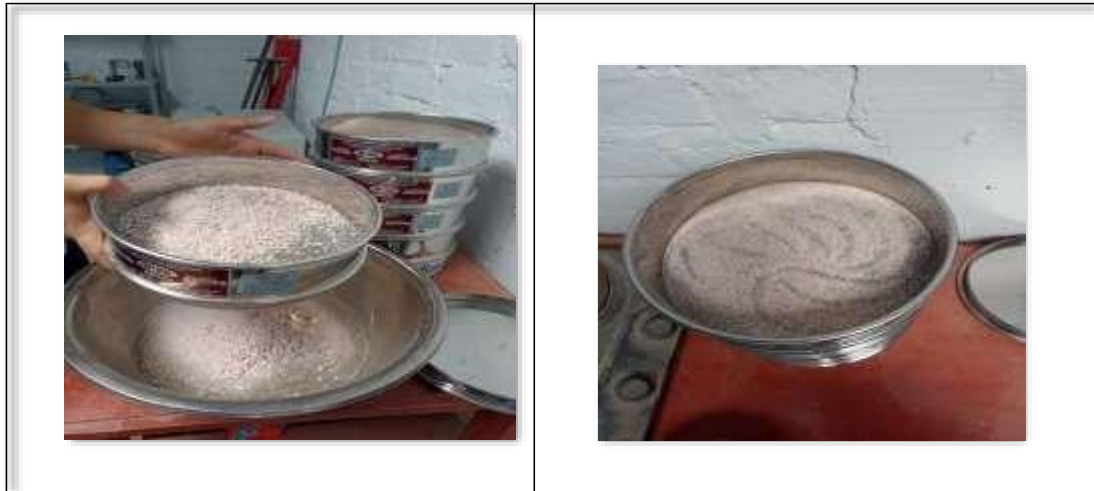
Figura 29: Tamizado de los agregados (Valva chancada de concha de abanico)
