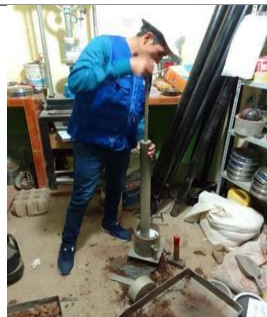
Fotografía N°11: Realizando la compactacion
