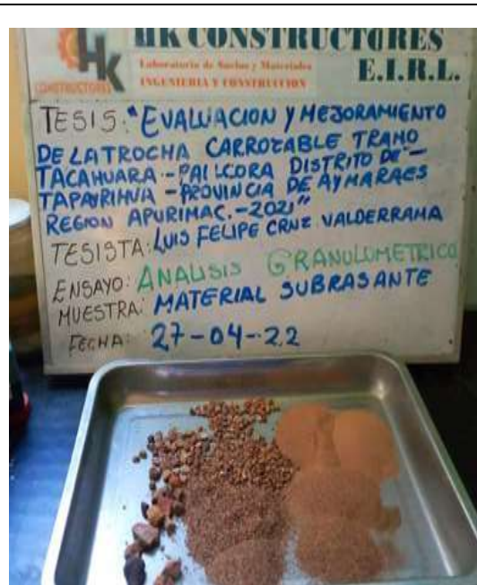
Fotografia N°6: Analisis granulometrico del subrasante
