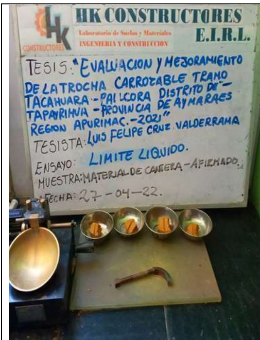
Fotografia N°5: medicion de limite de liquido de materia de cantera
