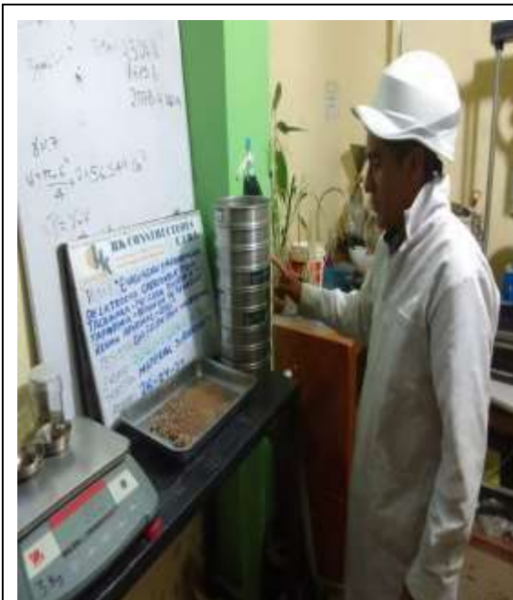
Fotografia N°5: Realizando el analisis granulometrico del subrasante
