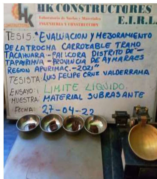
Fotografia N°8: Medicion de limite de liquido
