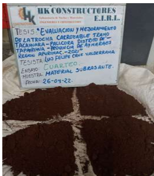
Fotografía N°11: Realizando el cuarteo del subrasante.
