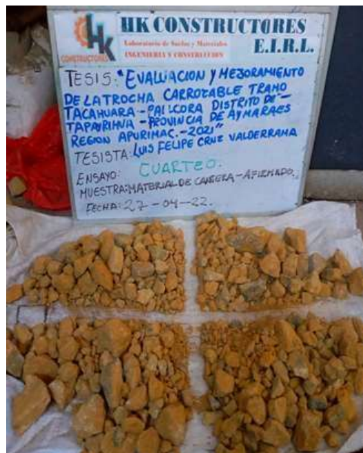
Fotografia N°5: Cuarteo del material de cantera
