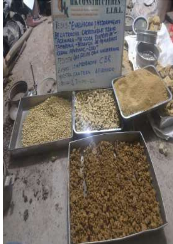
Fotografia N°4: Comprobacion de Agregado para la el Ensayo de CBR
