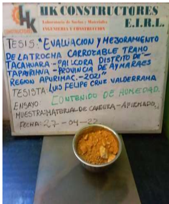
Fotografia N°5: medicion de contenido de humedad
