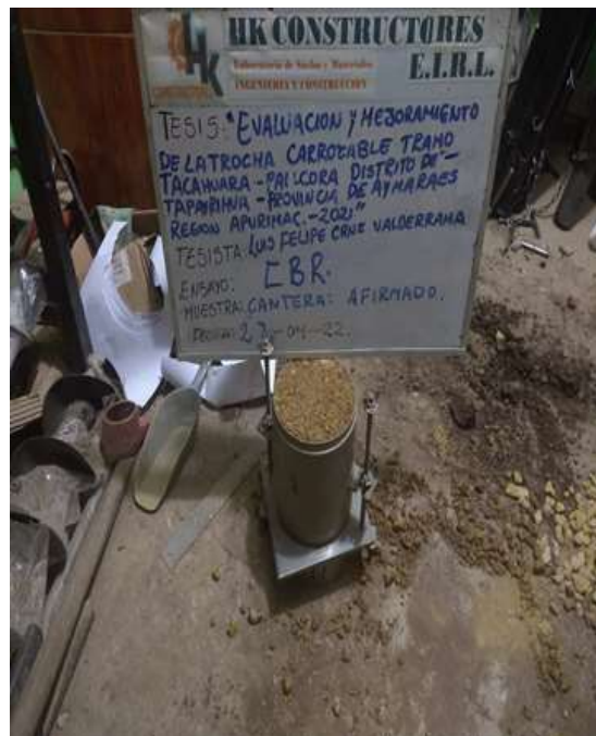
Fotografia N°5: compactacion para el CBR
