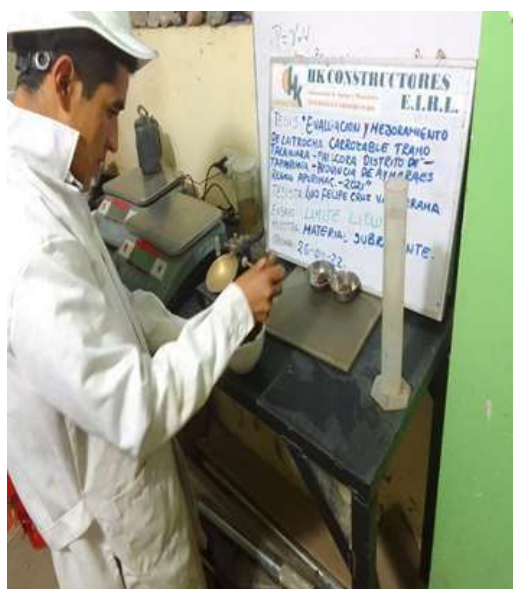
Fotografia N°7: Medicion de limite de liquido
