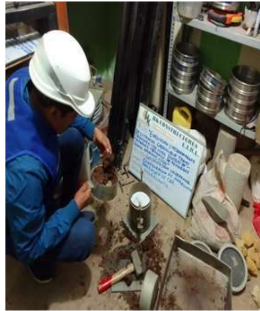
Fotografia N°8: Realizando comprobación de agregado para ensayo de CBR
