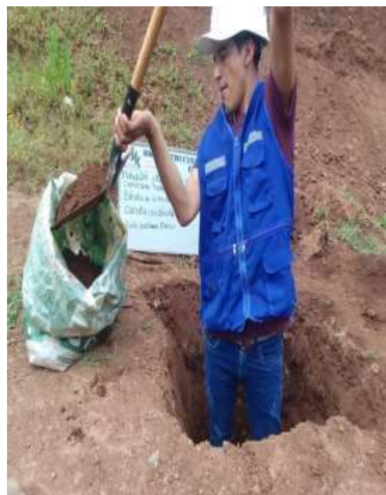
Fotografia N°4: Recogida de muestra de calicata en teleloyoc huaycco.
