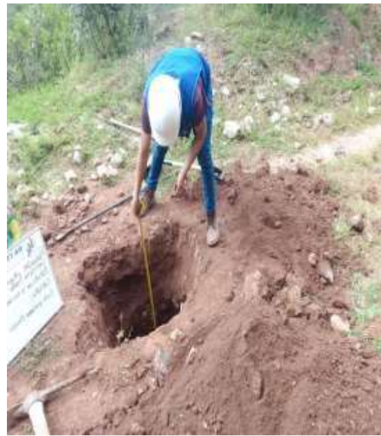
Fotografia N°2: Medicion de la profundidad de la calicata.
