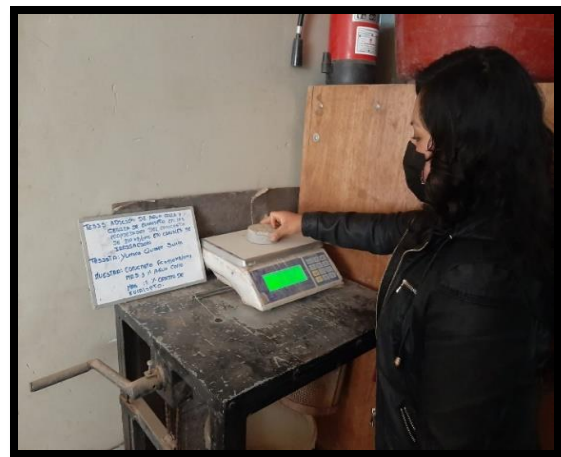
Grafico 45 : peso de la masa saturada después de la ebullición.
