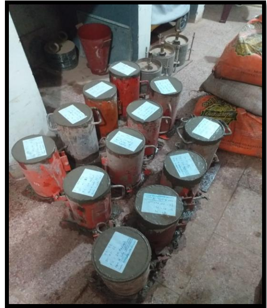
Grafico 32 : realizando las probetas de concreto con sus distintas dosificaciones
