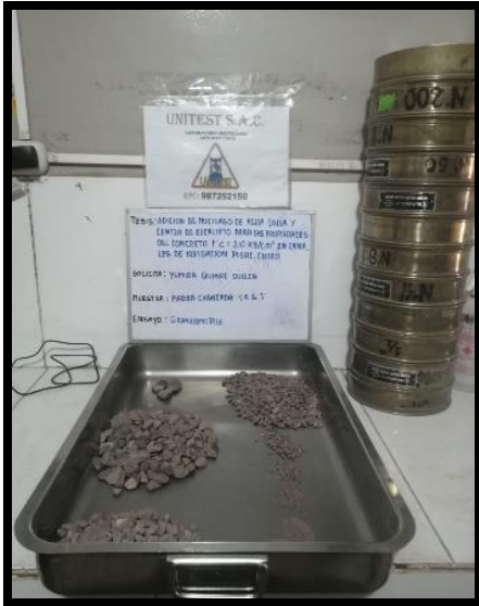
Gráfico 15 : tamizado del agregado grueso
