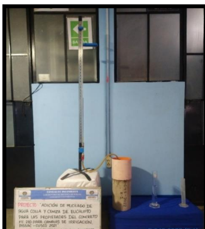
Grafico 41 : ensayo de permeabilidad bajo presión de agua con la adición del 3% de mucilago de agua colla y 15% de ceniza de eucalipto
