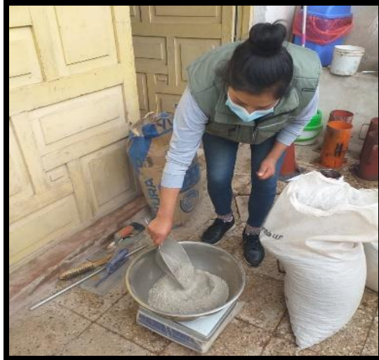
Grafico 26 : peso del cemento para realizar las probetas sin ninguna adición
