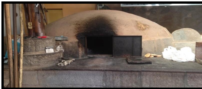
Grafico 1 : horno artesanal para obtener la ceniza de eucalipto
