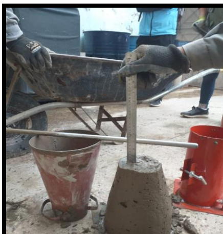
Grafico 23 : desmoldación para medir el asentamiento del slump de la mezcla
