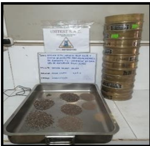
Gráfico 10 : tamizado del agregado fino
