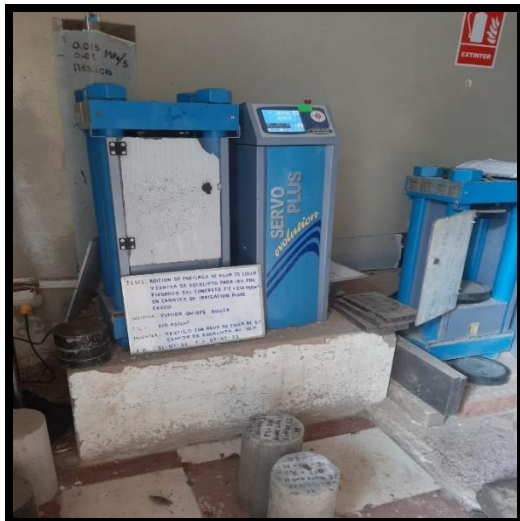
Grafico 40 : rotura de probetas a los 14 días de edad
