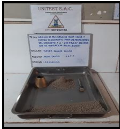
Gráfico 11 : ensayo de absorción del agregado fino
