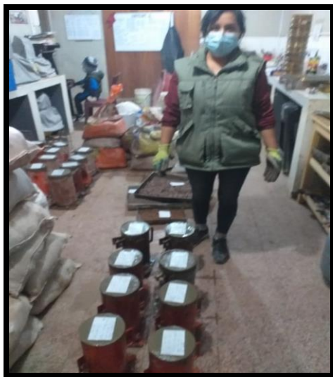
Grafico 34 : probetas de concreto estándar realizadas sin ninguna adición
