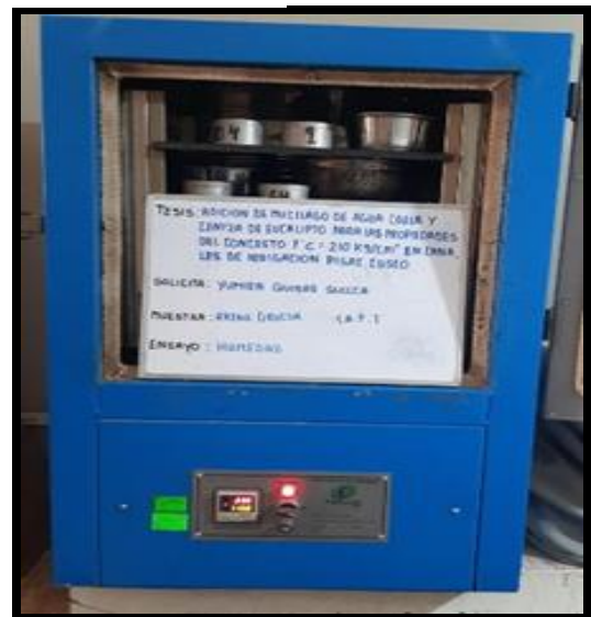
Gráfico 13: ensayo de humedad del agregado fino
