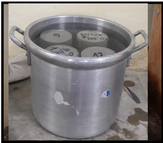
Grafico 46 : espécimen sumergido al agua para realizar la ebullición.
