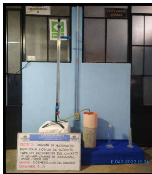
Grafico 42 . Ensayo de permeabilidad bajo presión de agua del concreto estándar
