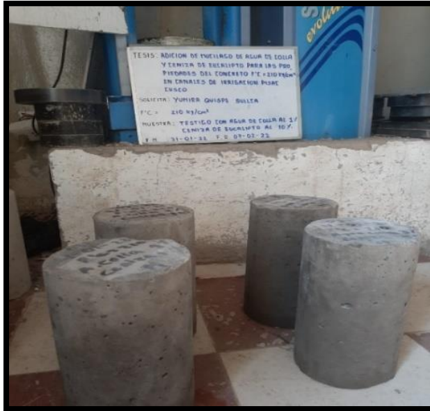
Grafico 38 : rotura de probetas a los 7 días de edad
