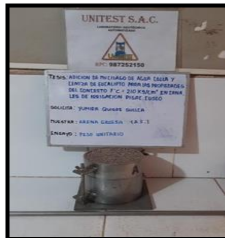
Gráfico 9 : ensayo del peso unitario del agregado fino
