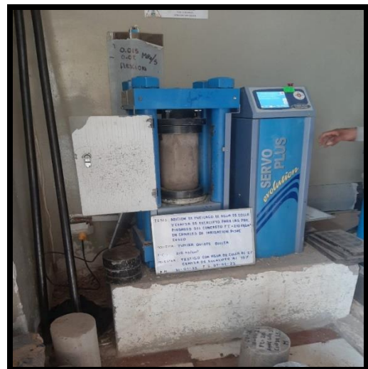
Grafico 39 : rotura de probetas a los 28 días de edad
