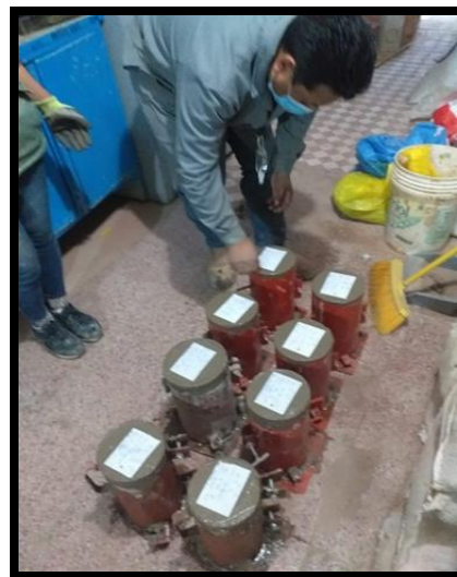
Grafico 33: Probetas de concreto realizadas con la adición del 3% de mucilago de agua colla y el 15% de ceniza de eucalipto
