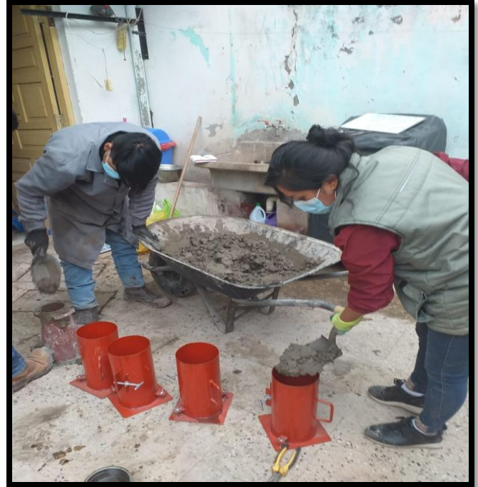
Grafico 30 : realizando las probetas de concreto con sus distintas dosificaciones
