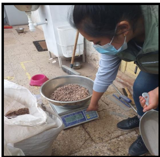
Grafico 25 : peso de la piedra chancada para realizar las probetas de concreto sin ninguna adición
