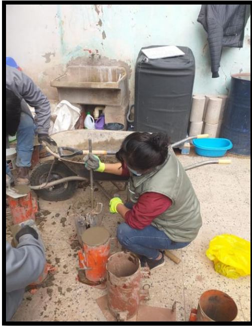
Grafico 31 : realizando los 25 golpes con la varilla en tres capas
