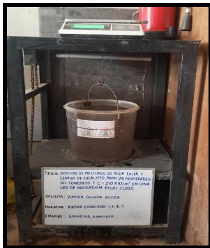
Gráfico 17 : gravedad específica del agregado grueso
