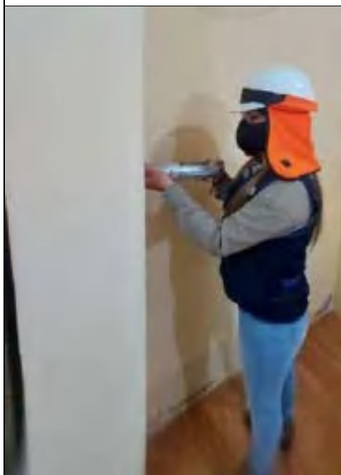
Foto 5: Ensayo de esclerometría en columna de Edificación 1.
