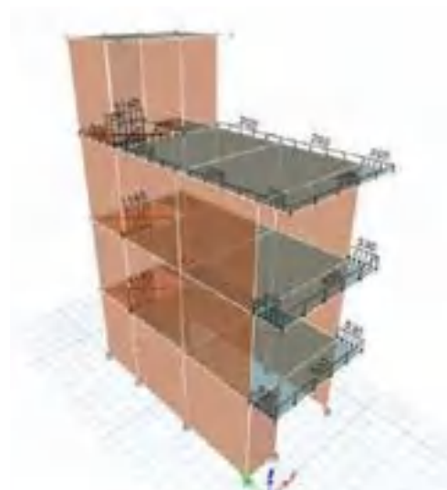
Figura 36. Carga muerta en losas Edificación 2-B.
