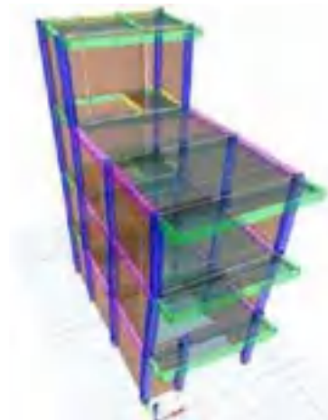
Figura 28. Detalle de irregularidad de rigidez extrema de Edificación 2-B.
