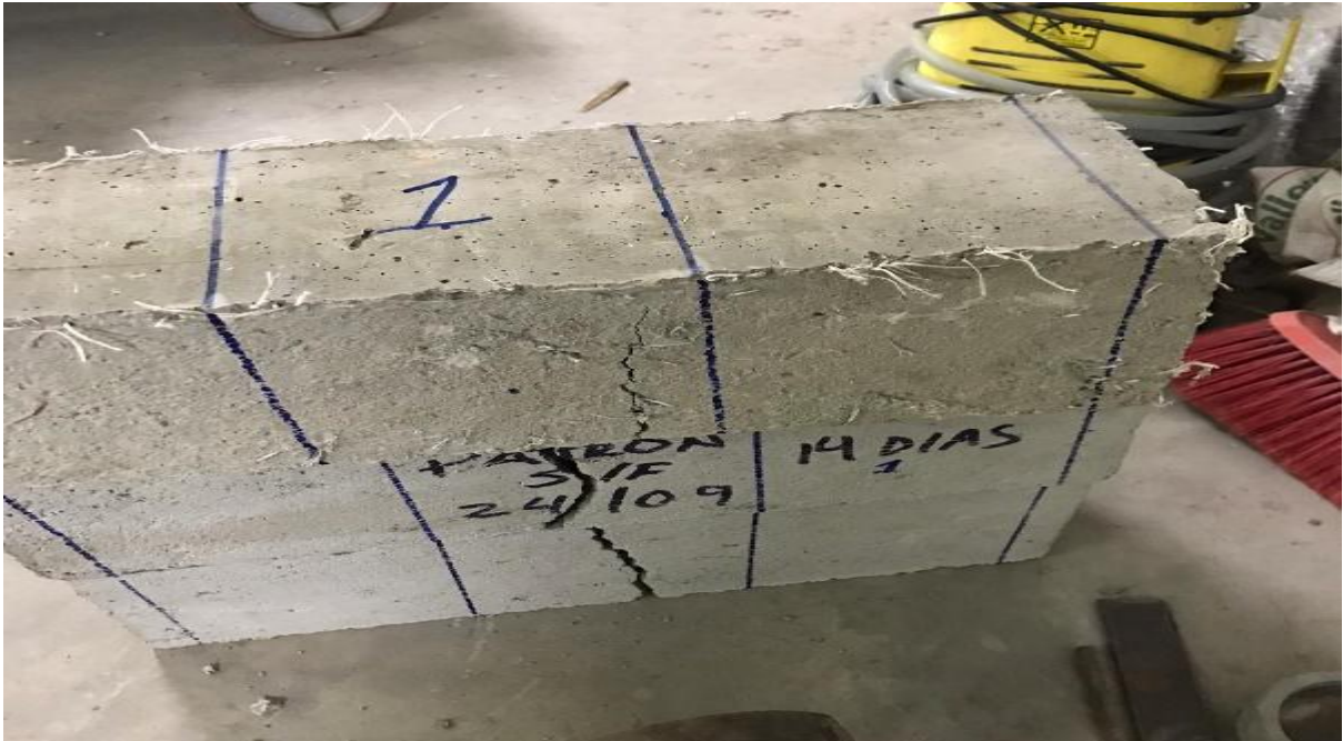
Figura 30: Ensayo de vigas por flexión Sin fibra y con fibra Fuente: Elaboración propia
