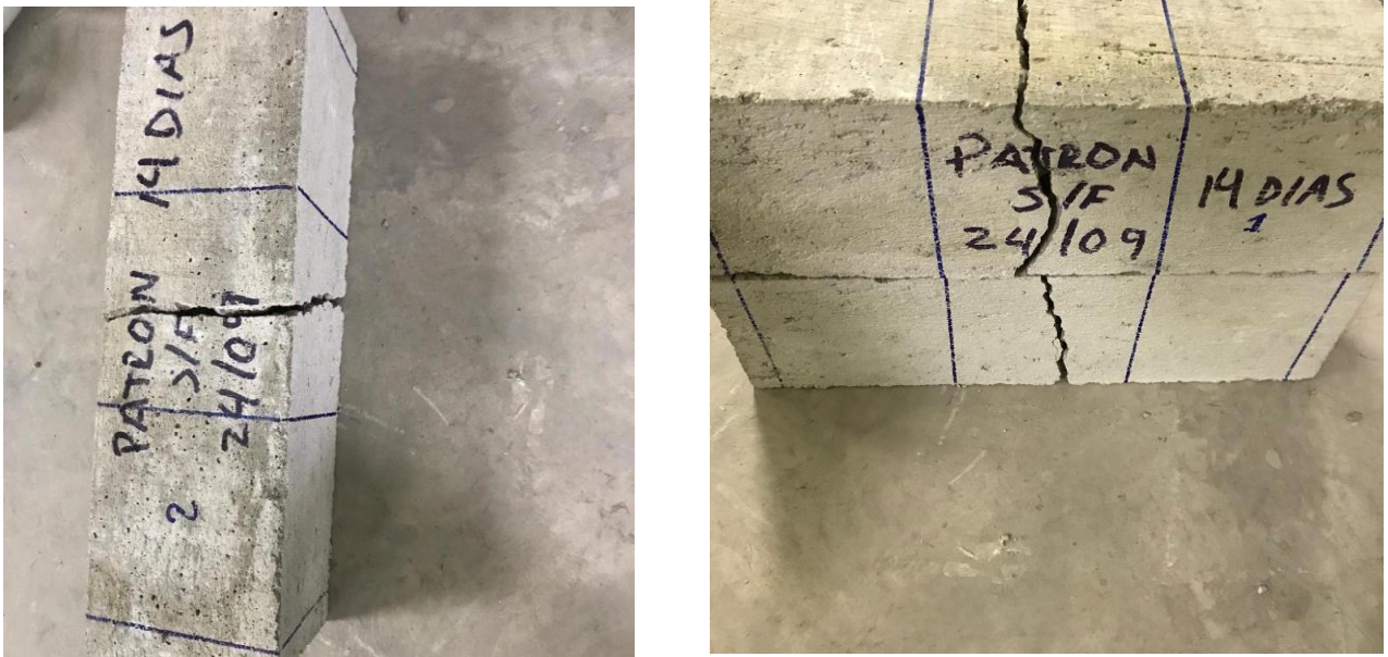
Figura 29: Ensayo de vigas por flexión Sin fibra y Con Fibra de polipropileno Fuente: Elaboración propia
