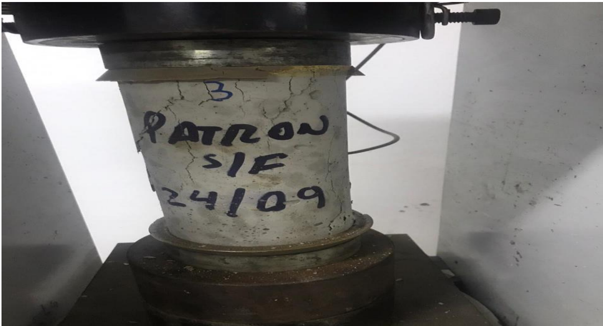
Figura 24: Ensayo a la compresión del concreto sin fibra (Prensa hidráulica) Fuente: Elaboración propia
