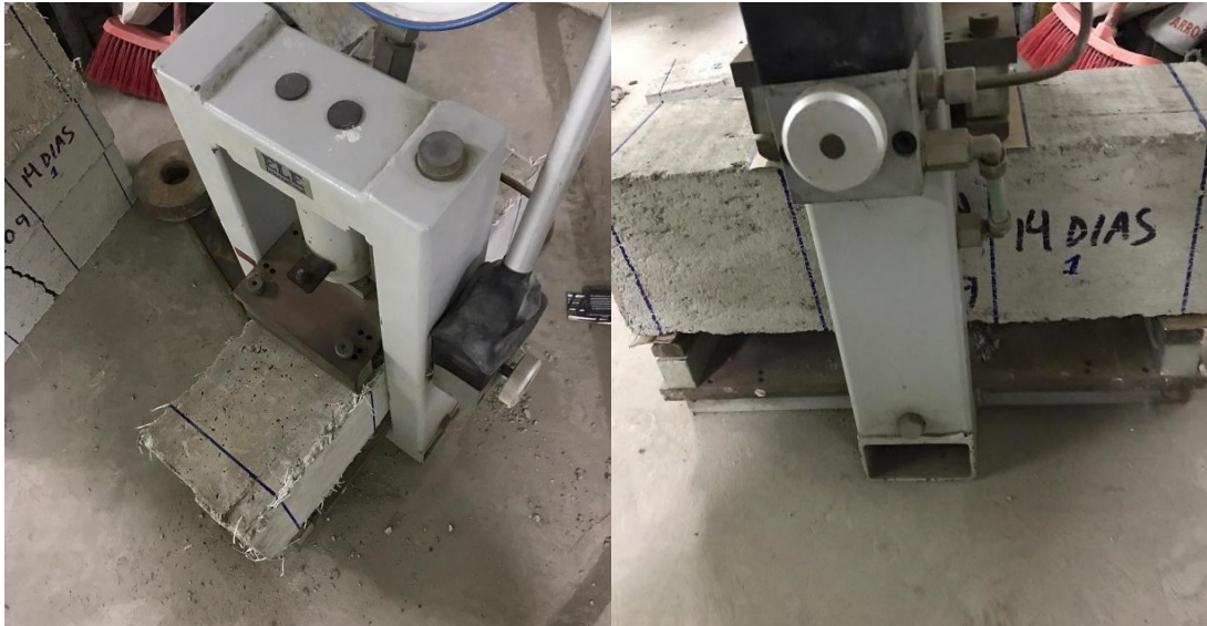
Figura 18. Muestra de vigas a flexión sin fibra y con fibra de polipropileno
