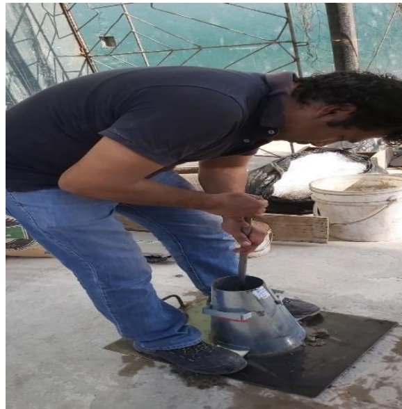
Figura 7. Prueba realizada por medio del asentamiento del concreto cono de Abrams.
