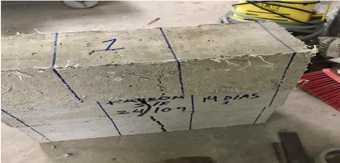
Figura 20. Ensayo de vigas por flexión sin adición de fibra y con adición de fibra.
