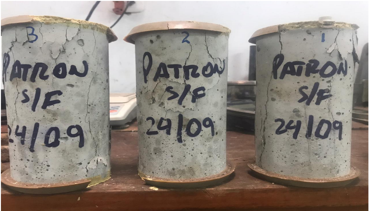
Figura 25: Muestra de probetas patrón, ensayo a la compresión del concreto sin fibra Fuente: Elaboración propia
