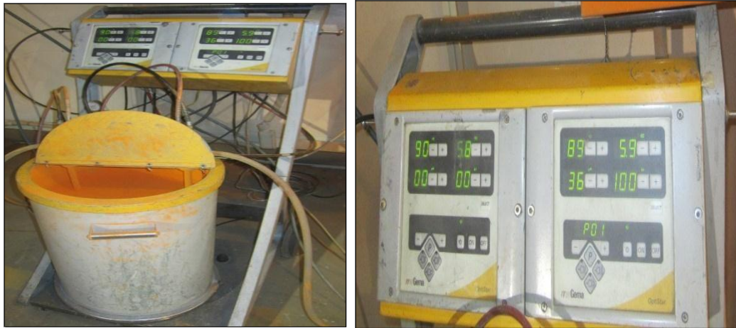
Ilustración 7. Puesta en marcha de equipo pintura en polvo
