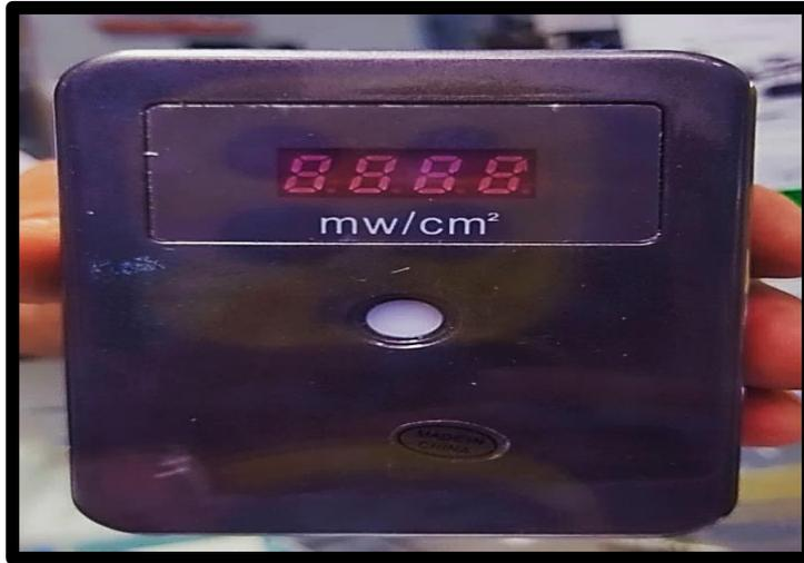
Fig. 13 Radiometro led, equipo para medir la intensidad de la luz led de la lámpara dental.
