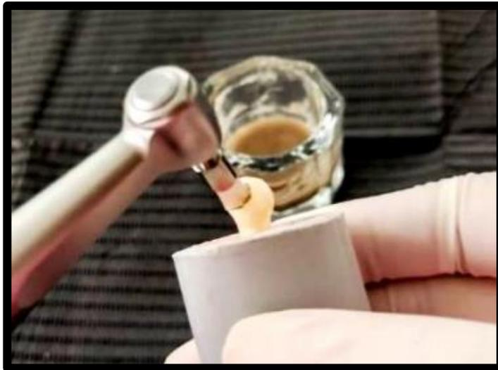
Fig. 5 Se realiza la profilaxis en la cara vestibular de la muestra, con una pasta a base piedra pómez y agua
