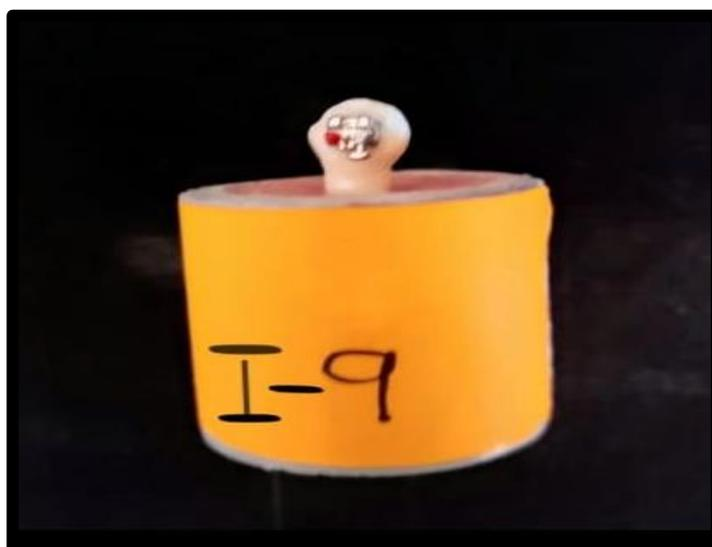
Fig. 16 Muestra de la pieza dental con el bracket metálico cementado.
