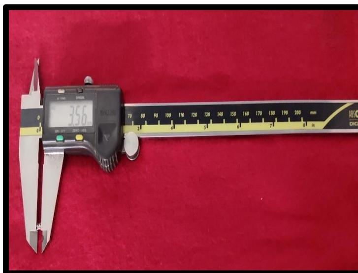
Fig. 20 Instrumento Pie de Rey sujetando el bracket Aditek para su medición.
