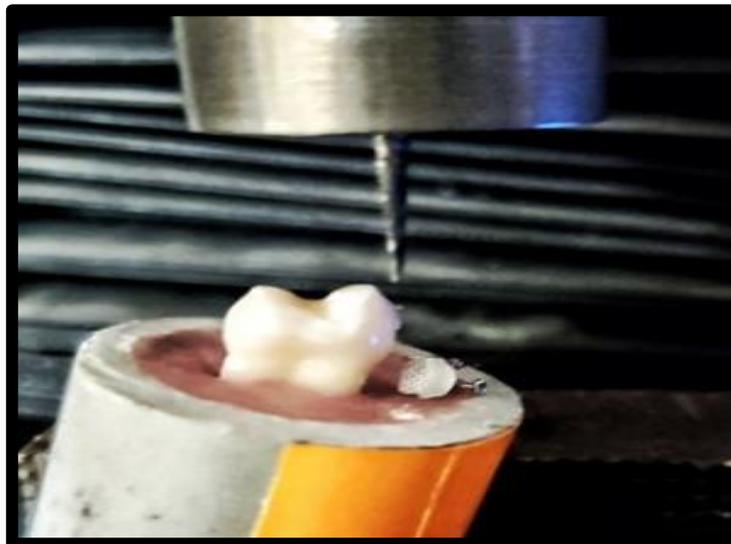
Fig. 18 Máquina de Ensayos ejercer un esfuerzo cortante hasta que se desprenda el bracket
