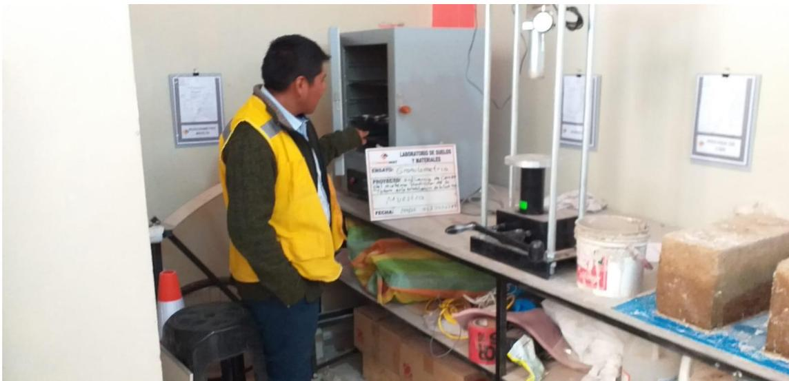
Figura 13. Ensayo de Californian Bearing Ratio
