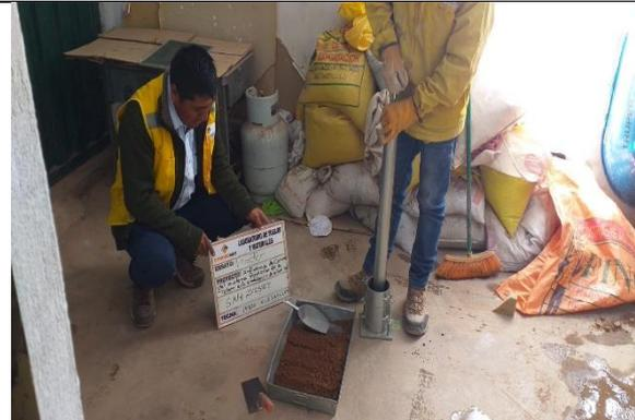
Fotografía 16. Ensayo de Proctor modificado
