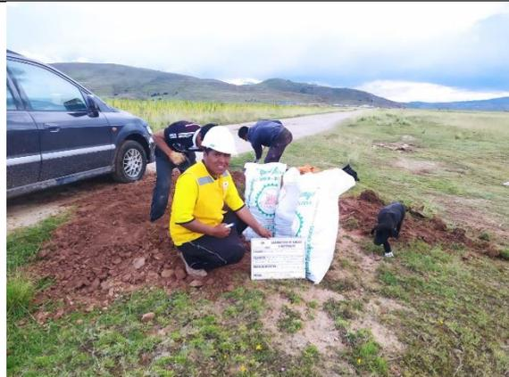
Fotografía 3. Excavación de calicatas
