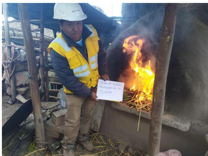
*Figura 7. Incineración del sistema radicular de la totora*
