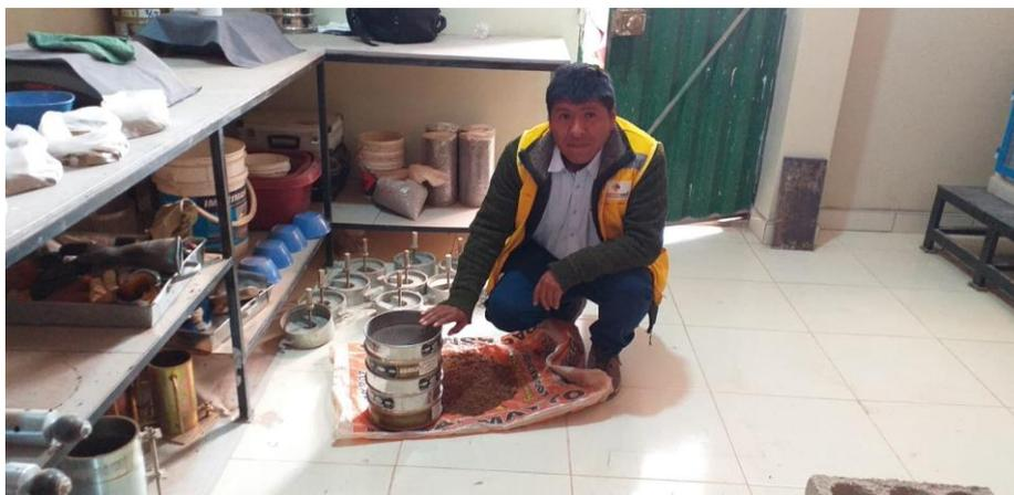
*Figura 9. Ensayo de análisis granulométrico*
