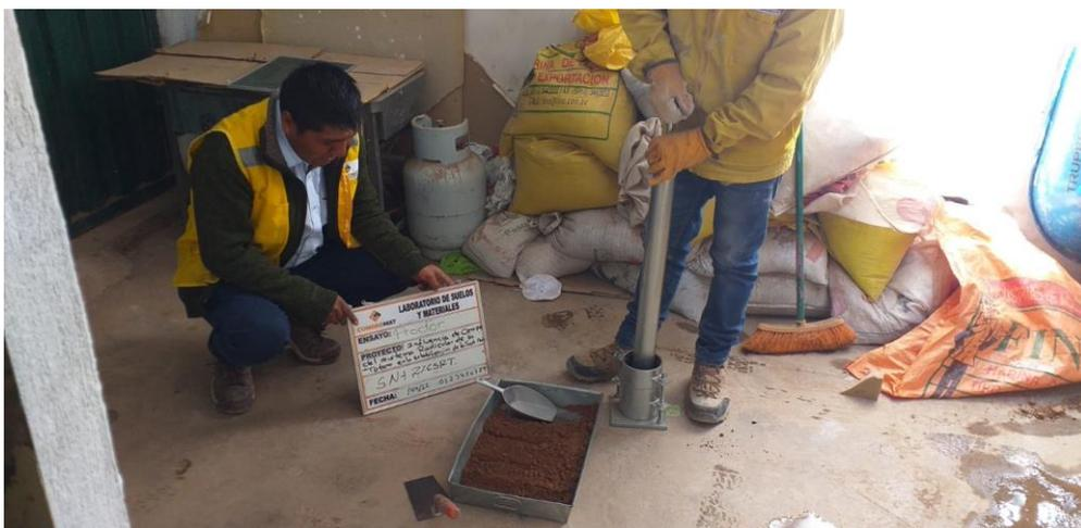
Figura 12. Ensayo de Proctor modificado
