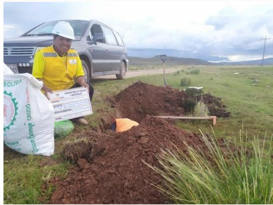
Fotografía 1. Excavación de calicatas
