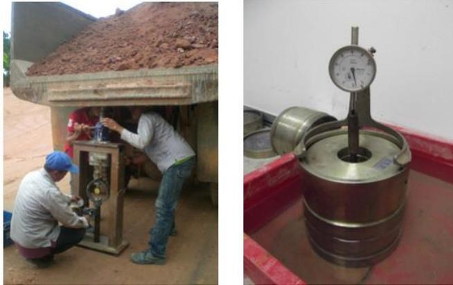
Figura 1. Ensayo de CBR in situ y laboratorio, tomado de « Comparative evaluation of soil subgrade strength using laboratory and in-situ tests» por Arshad et al. (2018, p. 1185).
