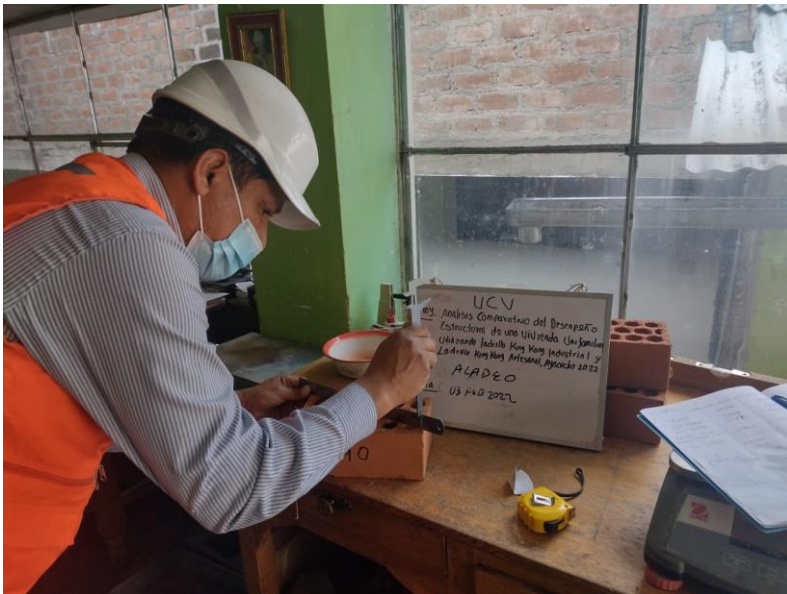
Ensayo de alabeo
