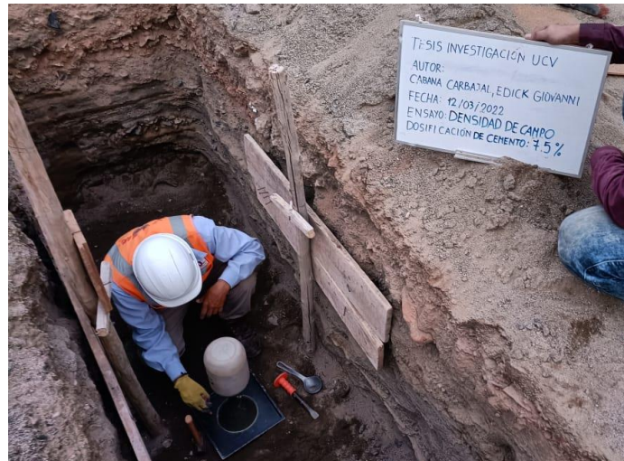
Figura 65. Ensayo de Cono de Arena en Suelo Cemento 7.5%.
