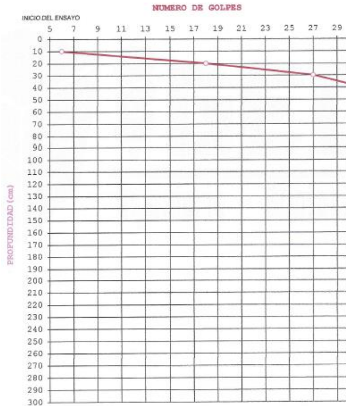
Figura 68. Curva “Número de Golpes – Profundidad” (Suelo-Cemento 5%).
