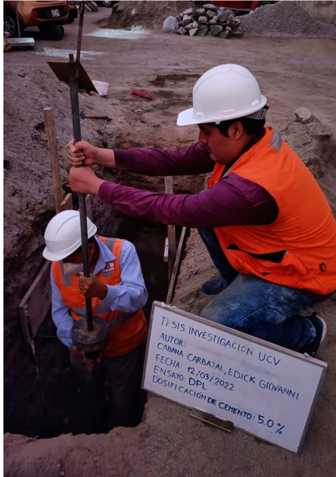
Figura 92. Ensayo de Penetración Dinámica en la Capa de Mejoramiento.
