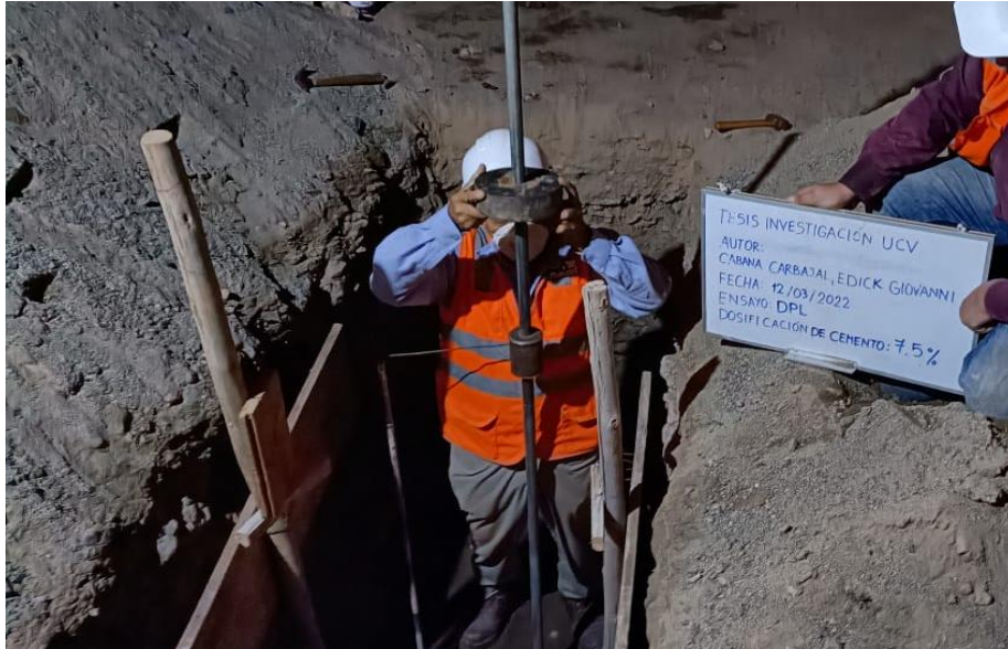
Figura 69. Ensayo DPL in situ para Suelo-Cemento 7.5%.
