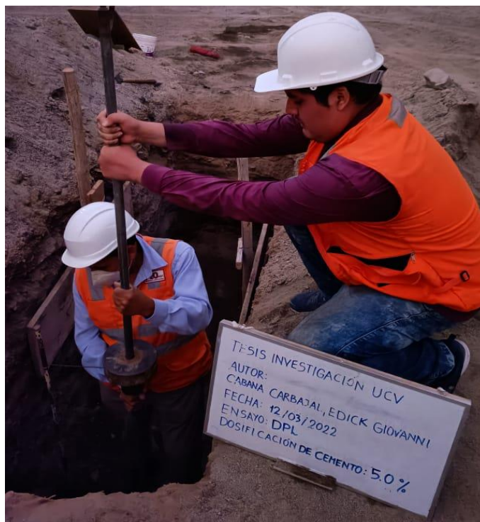
Figura 67. Ensayo DPL in situ para Suelo-Cemento 5%.
