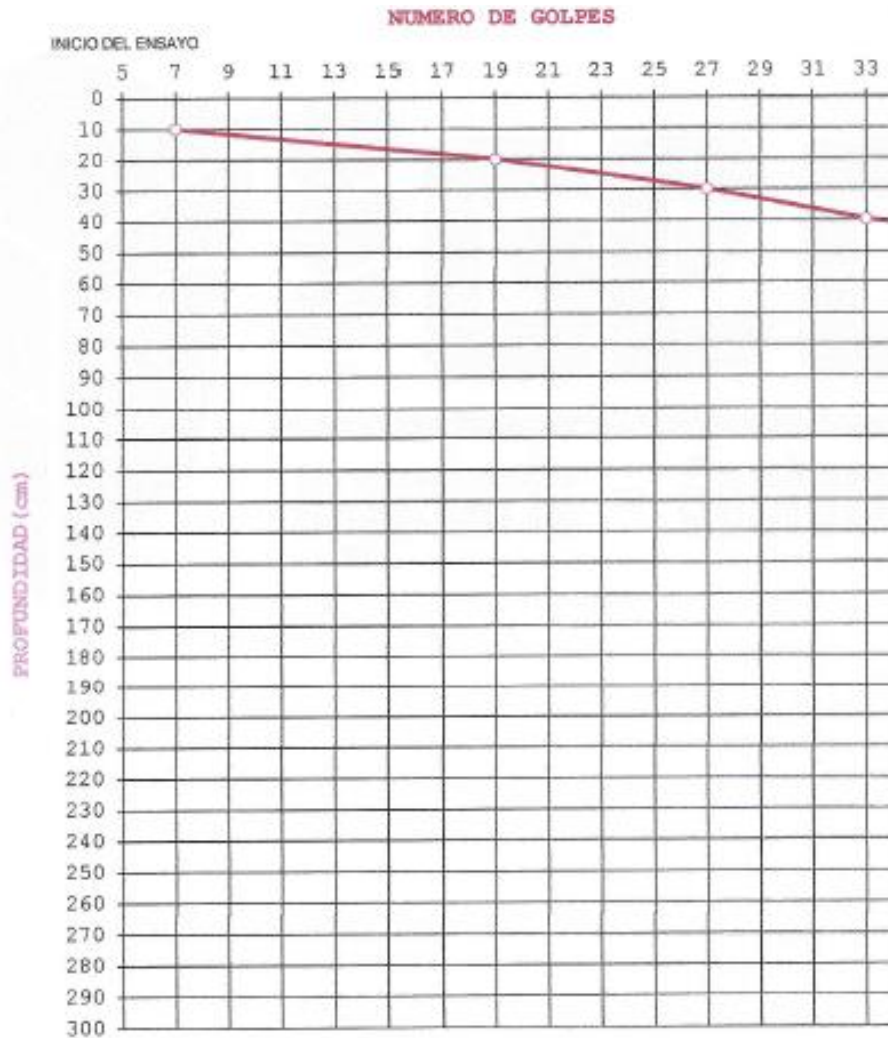
Figura 70. Curva “Numero de Golpes – Profundidad” (Suelo-Cemento 7.5%).
