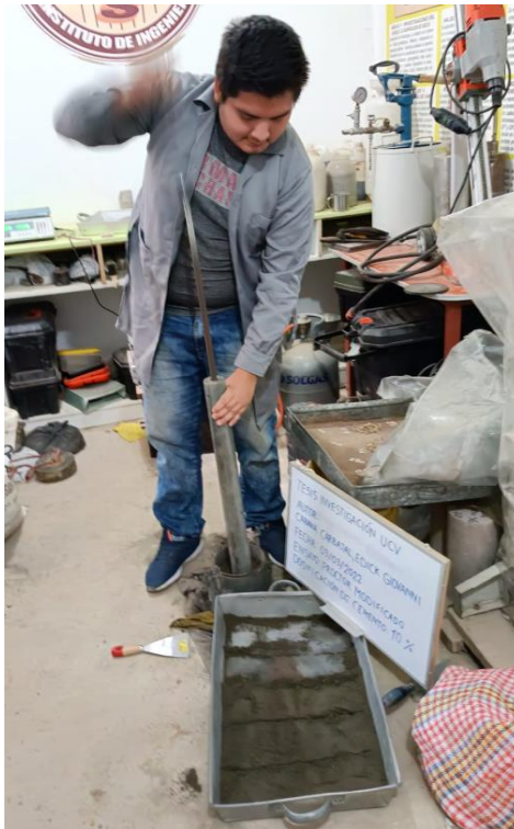
Figura 53. Ensayo Proctor del Suelo Cemento.
