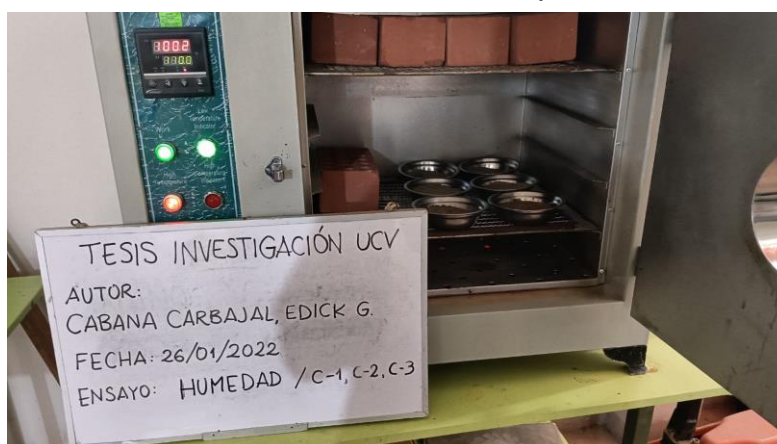
Figura 35. Taras con el Suelo natural en el Horno.
