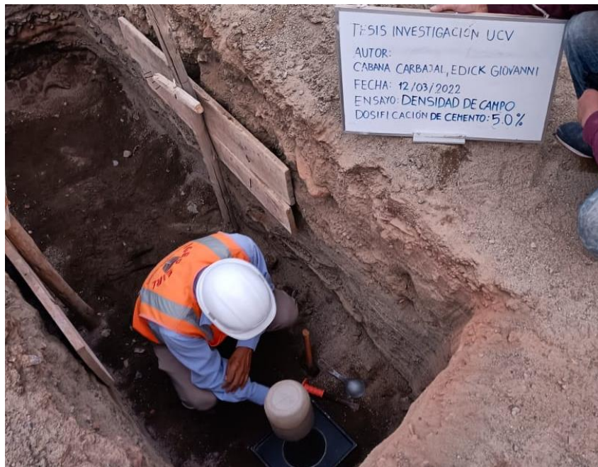
Figura 82. Cono de Arena, Placa Metálica, Cucharón, Martillo y Arena Calibrada
