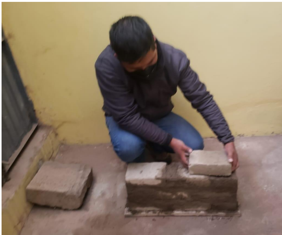
Fotografía N° 6: Elaboración de murete
