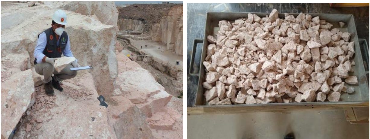
Figura 8: Proceso extraccion y trituracion de la ignimbrita
