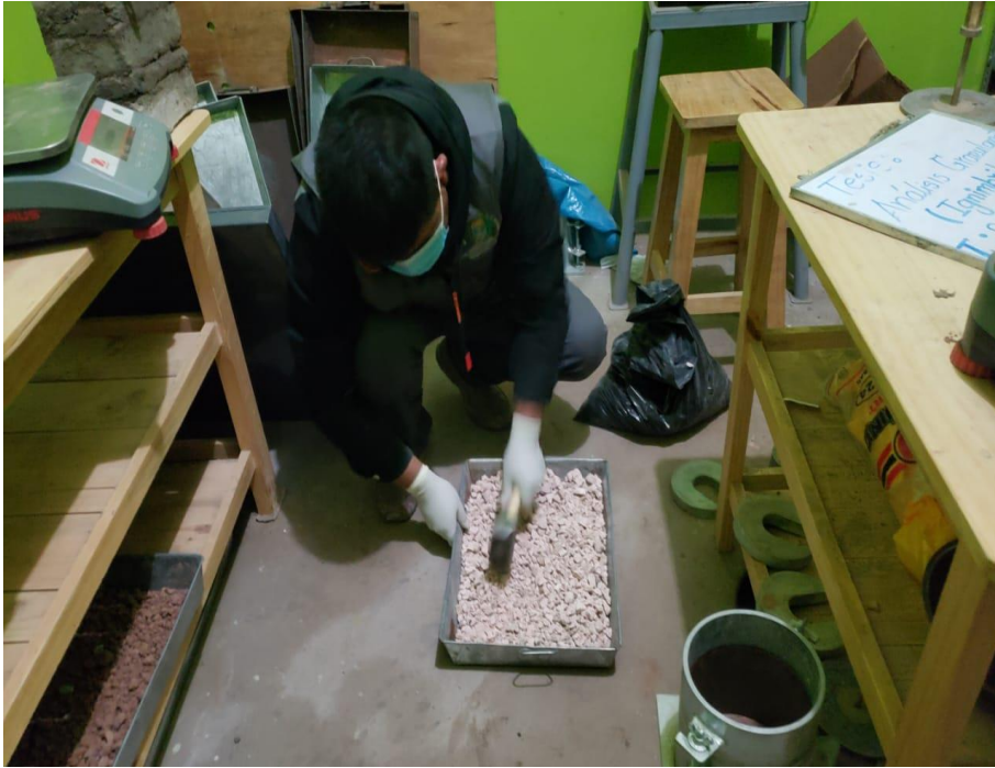
Fotografía N° 3: Triturado de muestra de ignimbrita.
