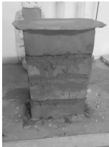
Figura 9: Pila de ladrillo
