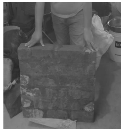
Figura 13: Prueba a compresión corte o diagonal
