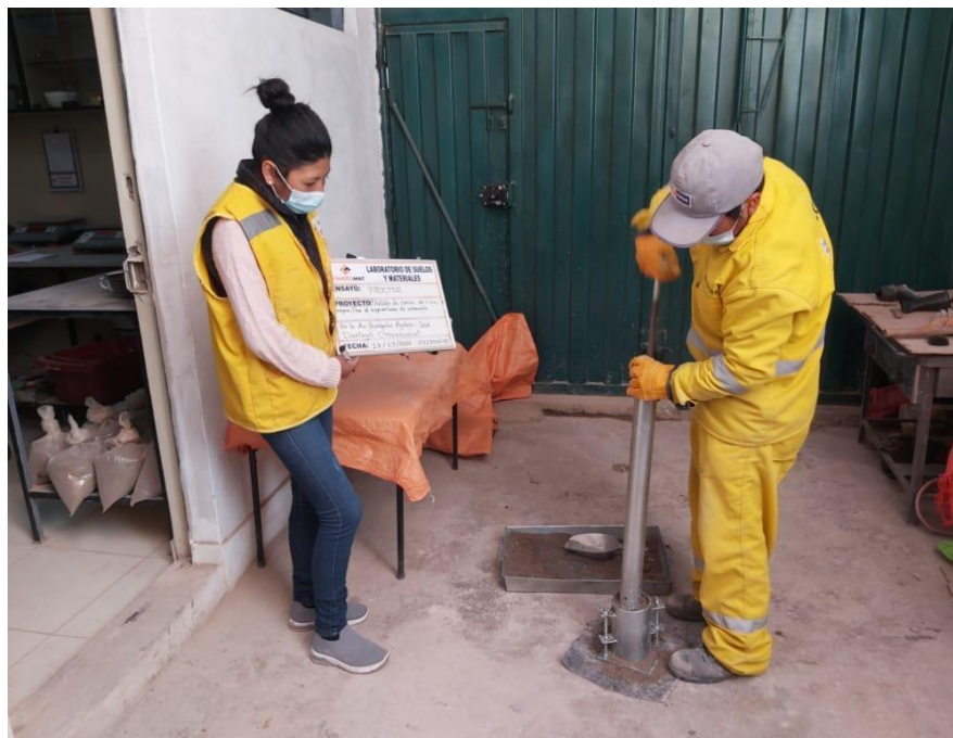
Fotografía 8: Ensayo de Proctor Modificado Fuente: Elaboración propia.
