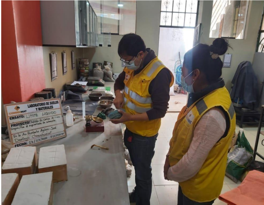
Fotografía 7: Ensayo de Límites de Atterberg Fuente: Elaboración propia.
