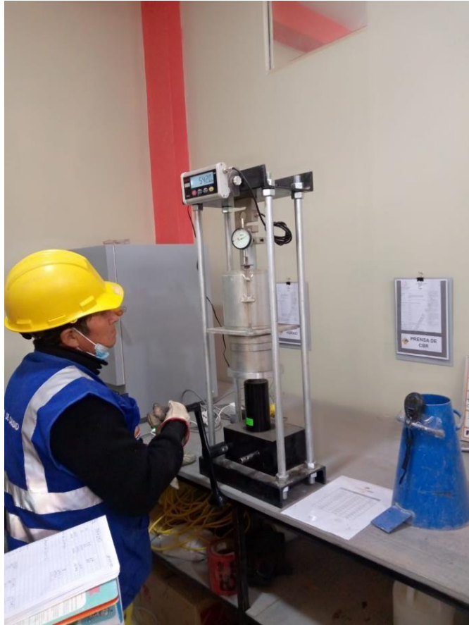
Fotografía 9: Ensayo de CBR en laboratorio Fuente: Elaboración propia.
