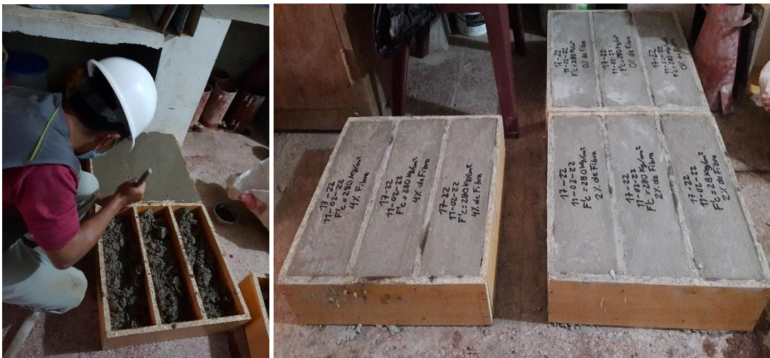
Figura 29: Apisonado por varillado y vigas con 2% y 4% de fibra de hojalata reciclada
