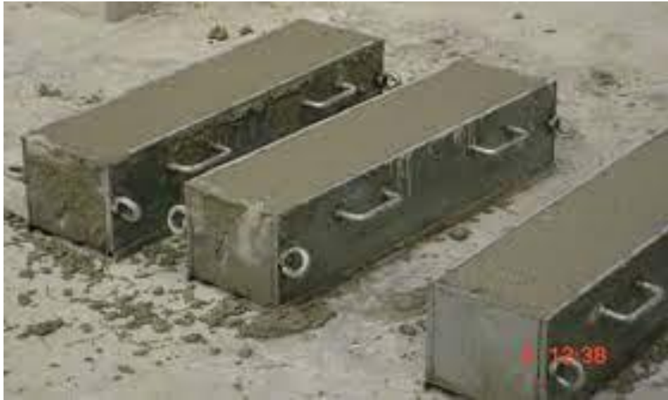
Figura 12: Probetas prismáticas de concreto (vigas)
