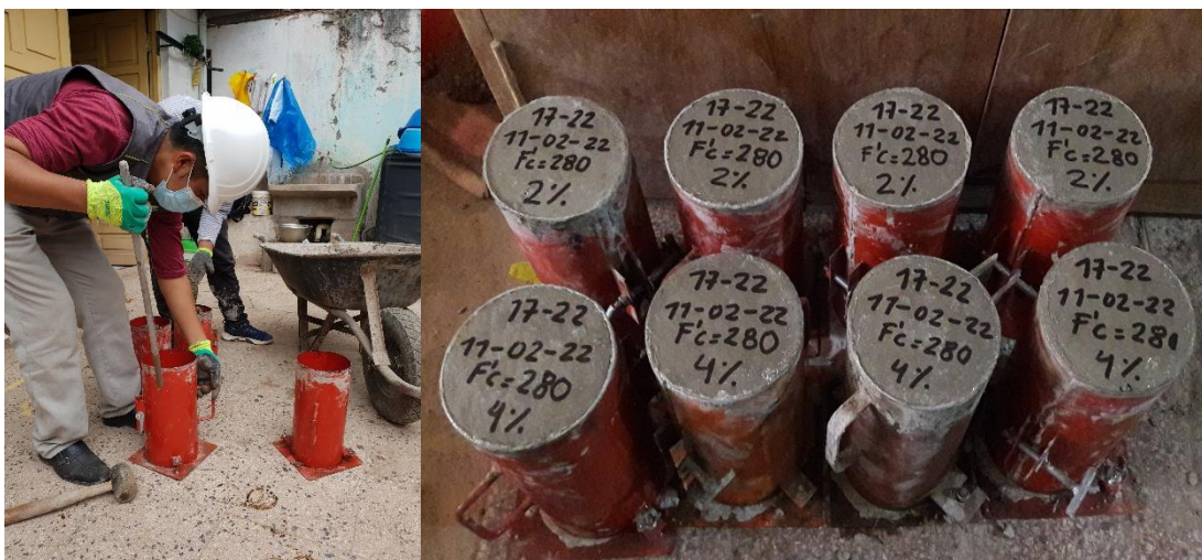
Figura 27: Apisonado por varillado y briquetas con 2% y 4% de fibra de hojalata reciclada.
