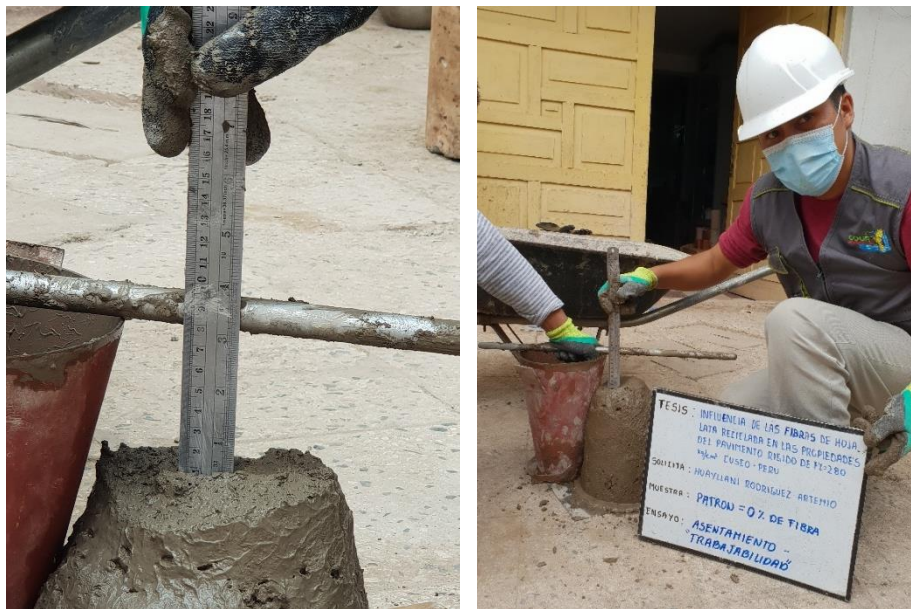
Figura 32: Ensayo de asentamiento mediante el cono de Abrams
