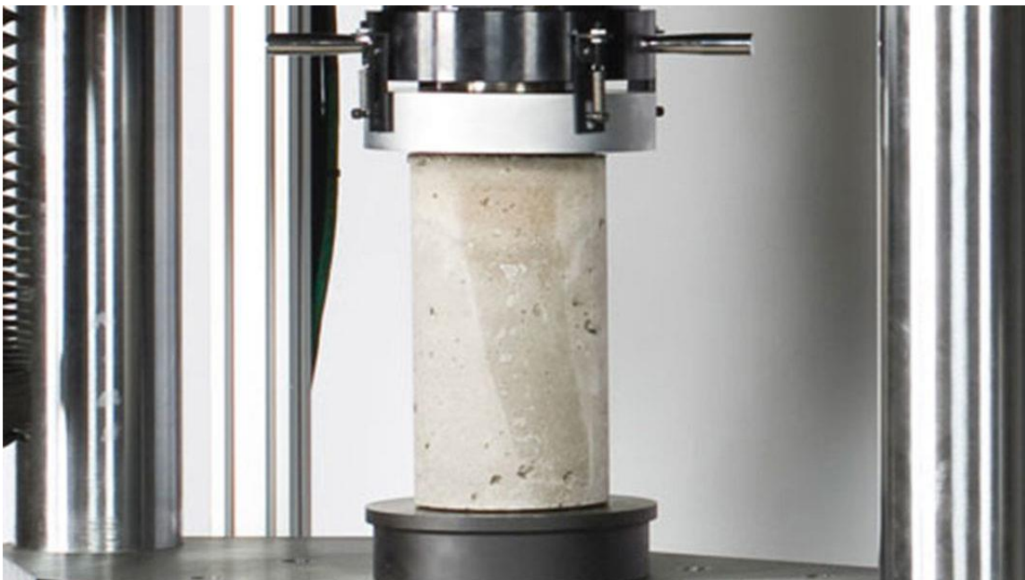
Figura 8: Ensayo de Compresión con Probetas Cilíndricas
