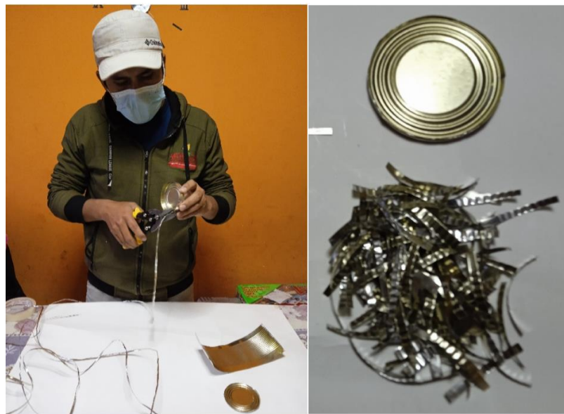
Figura 18: Procesamiento de fibras de hojalata reciclada
