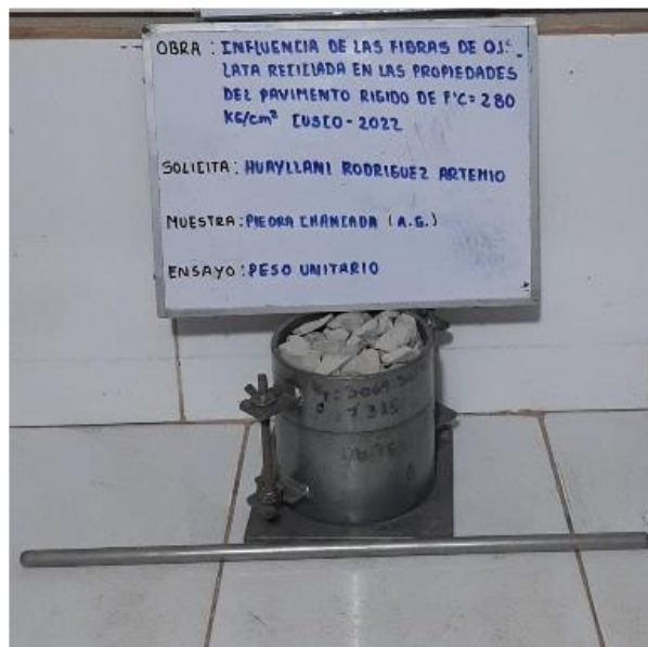
Figura 23: Ensayo de peso específico unitario del agregado grueso
