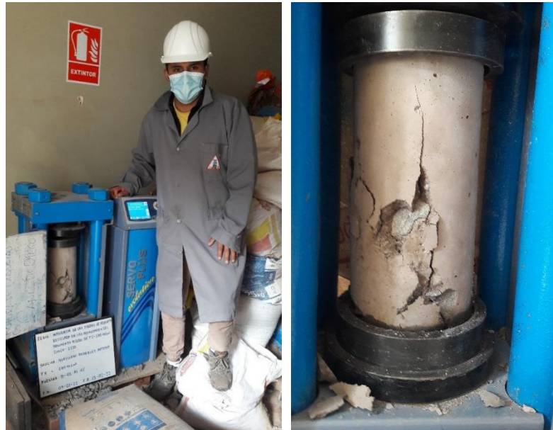
Figura 38: Ensayo de Resistencia a esfuerzo de compresión
