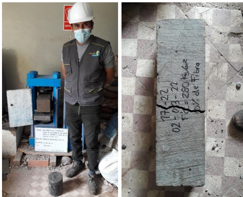
Figura 41: Ensayo de resistencia a la flexión de Vigas
