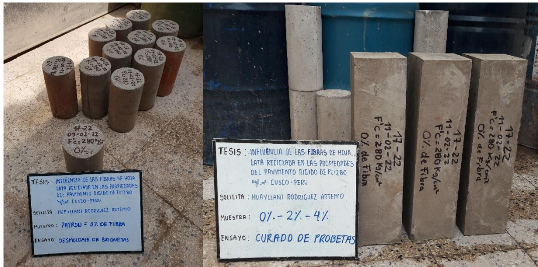
Figura 30: Codificación de Briquetas y Vigas
