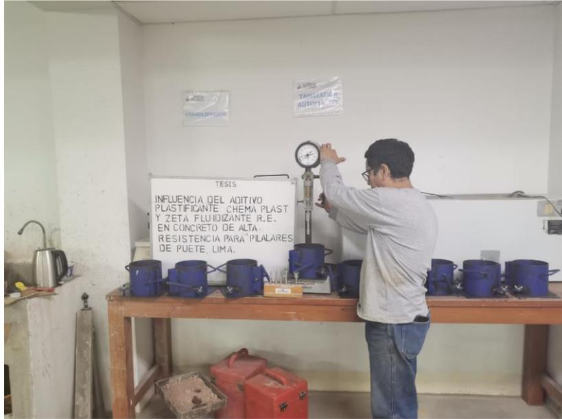
***Ilustración 24 Penetrómetro Acme fraguado de concreto con aditivos***
