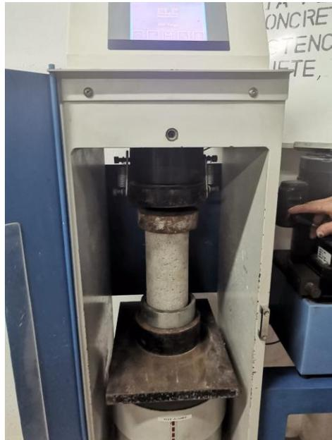
***Ilustración 21 Resistencia a la compresión aditivo 0.5% chema***
