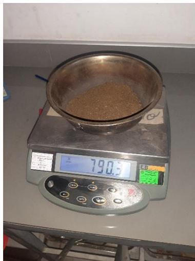
***Ilustración 9 Peso del agregado fino***
