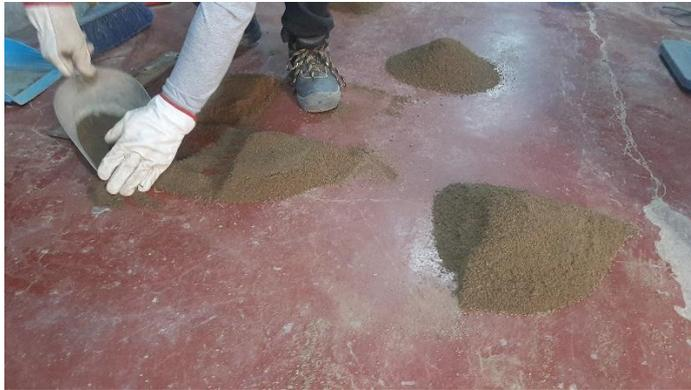
***Ilustración 6 Cuarteo de agregado fino***
