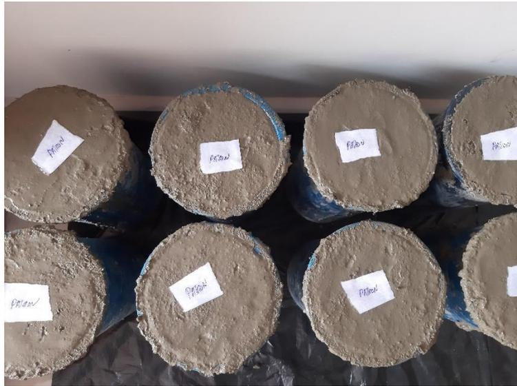
***Ilustración 19 probetas patrón***
