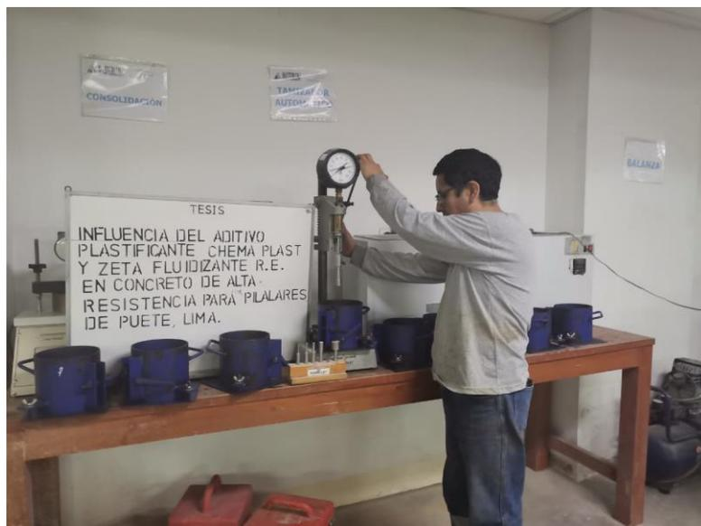
***Ilustración 23 Penetrómetro Acme fraguado de concreto***
