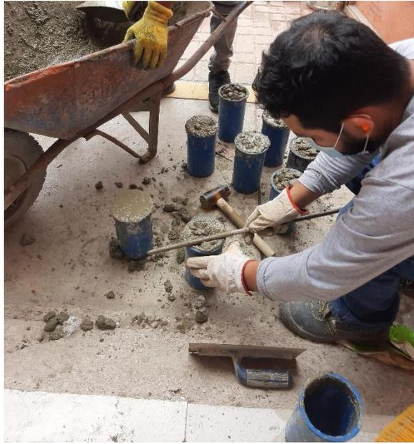
***Ilustración 18 Probetas cilíndricas***
