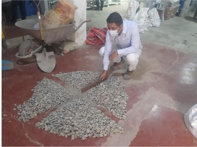
***Ilustración 5 Cuarteo de agregado grueso***
