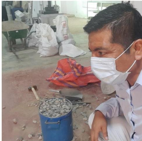
***Ilustración 7 Peso unitario del agregado grueso***
