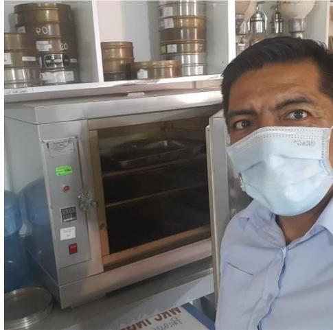
***Ilustración 11 Horno para secado de los agregados***
