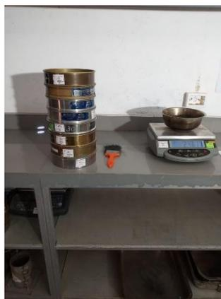
***Ilustración 4 Tamices para ensayo granulométrico***
