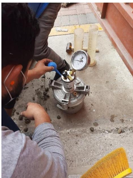
***Ilustración 16 Prueba contenido de aire***
