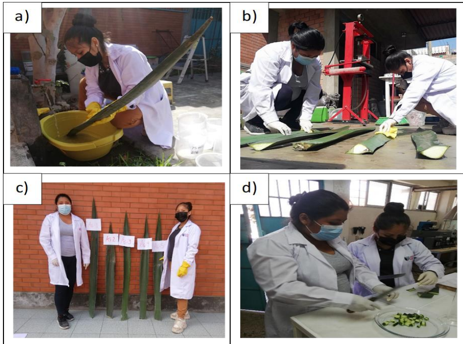
Figura 10. Acondicionamiento: a) lavado, b) secado, c) codificación y d) cortado de la hoja del Agave americana
