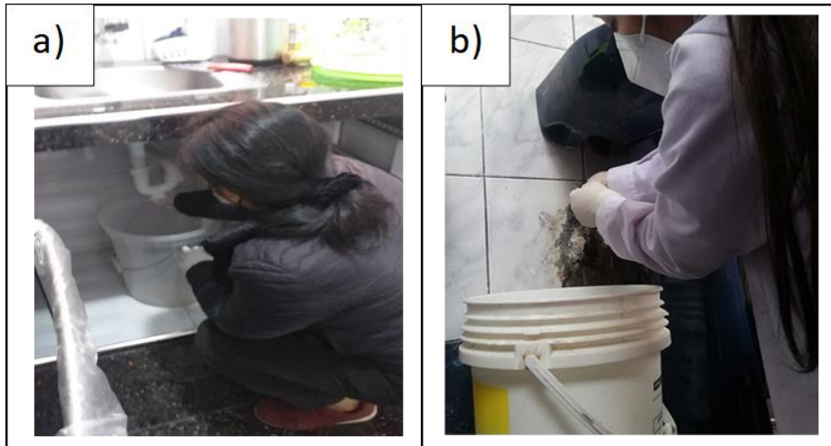
Figura 7. Toma de muestra de aguas grises: a) desagüe de lavadero, b) desagüe de lavamanos
