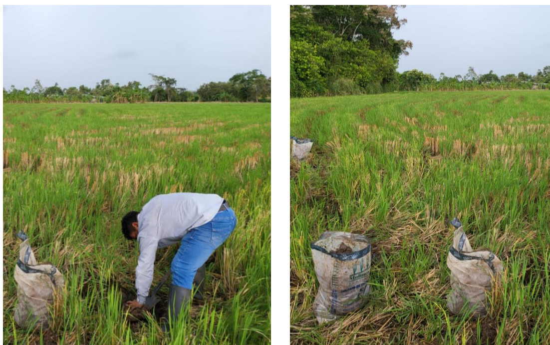
Fig. Recolección de 108 kilogramos de suelo colectados de 20 cm de profundidad
