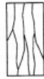
Tipo 3 Fisuras verticales encolumadas a través de ambos extremos, conos no bien formados
