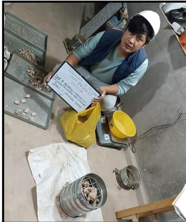
**Foto N° 16.** Selección del material para el ensayo de abrasión.
