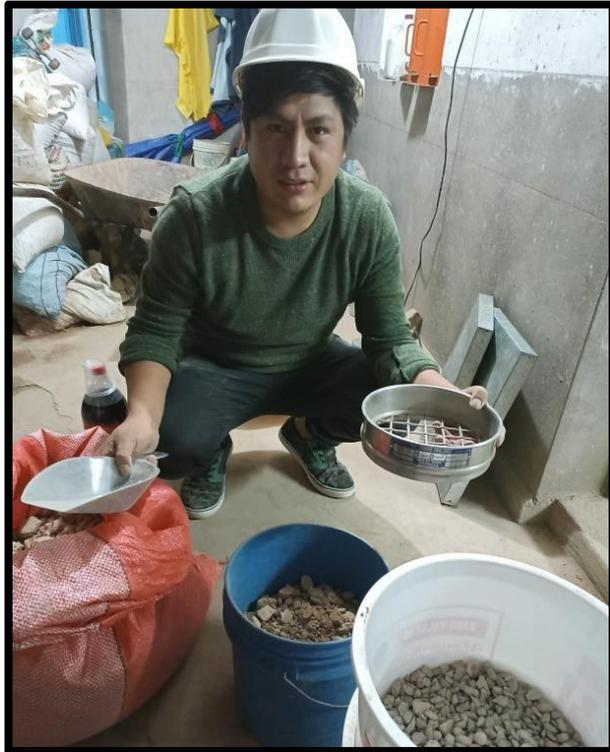
**Foto N° 5.** Selección del material para el ensayo Próctor modificado.
