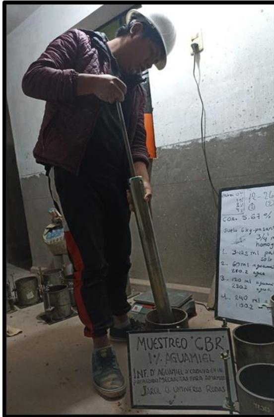
**Foto N° 13.** Compactación del material con 1% de aguamiel de cabuya para el ensayo CBR.
