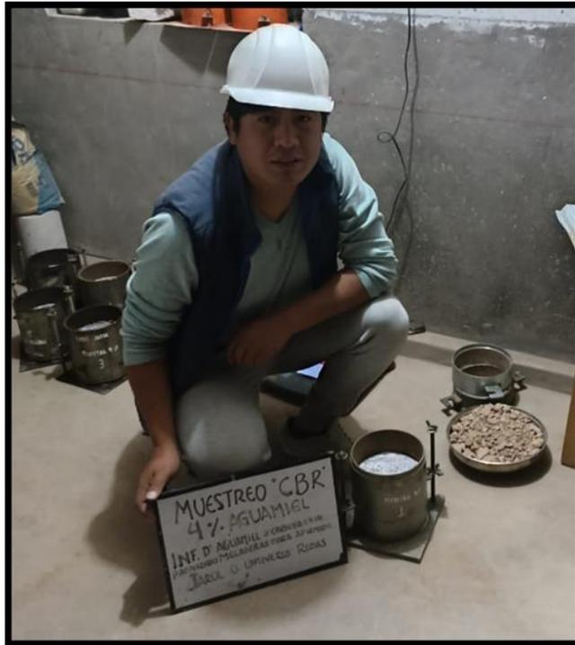
**Foto N° 15.** Muestreo y compactación del material con 4% de aguamiel de cabuya para el ensayo CBR.
