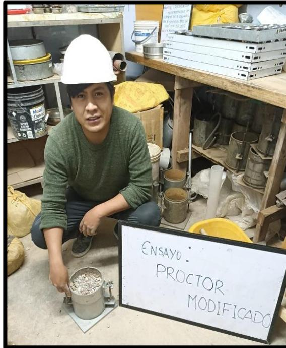
**Foto N° 7.** Molde para el ensayo Proctor modificado de la muestra patrón.
