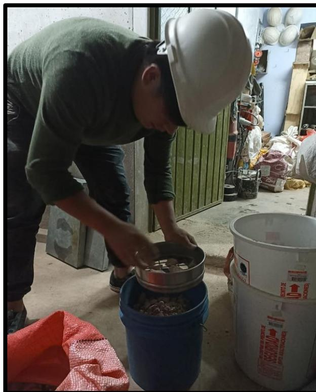
**Foto N°6.** Tamizado de los agregados para el ensayo Proctor modificado
