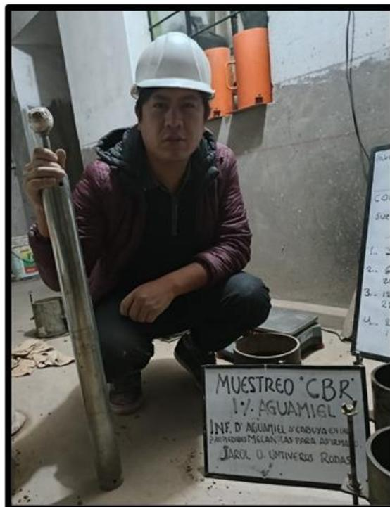
**Foto N° 12.** Muestreo del material con 1% de aguamiel de cabuya para el ensayo CBR.
