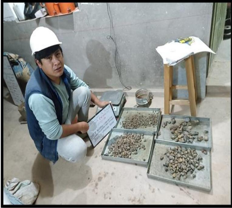
**Foto N° 17.** Tamizado del material para el ensayo de abrasión.
