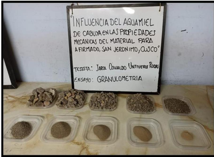
**Foto N° 25.** Clasificación de las partículas del material para afirmado luego del ensayo granulométrico.
