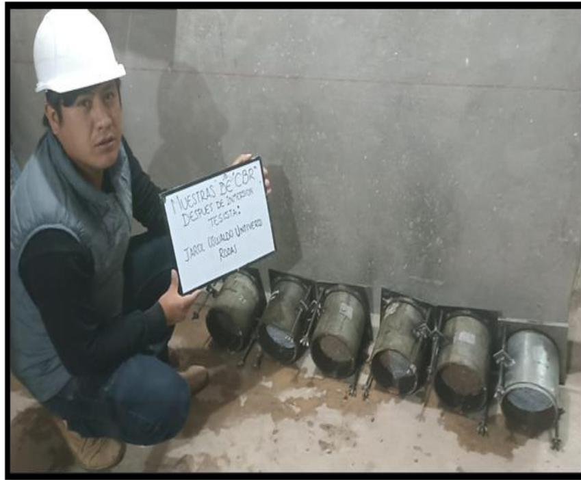
**Foto N° 27.** Muestras húmedas, listas para determinar el CBR del material para afirmado.
