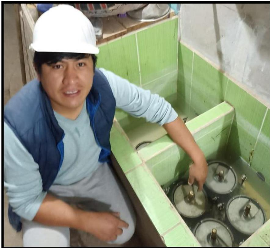
**Foto N° 26.** Inmersión de las muestras para determinar el CBR del material.
