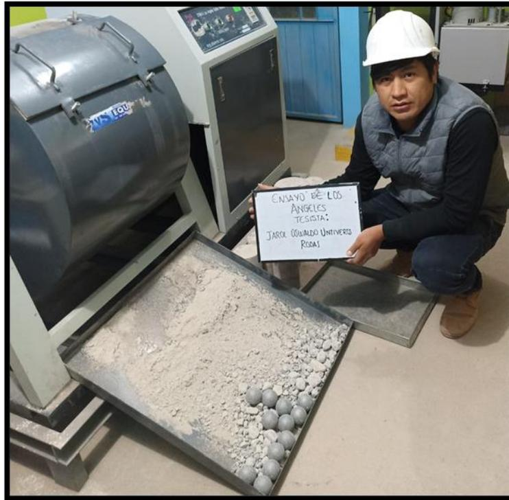
**Foto N° 19.** Ensayo de abrasión o de Los Ángeles culminada.
