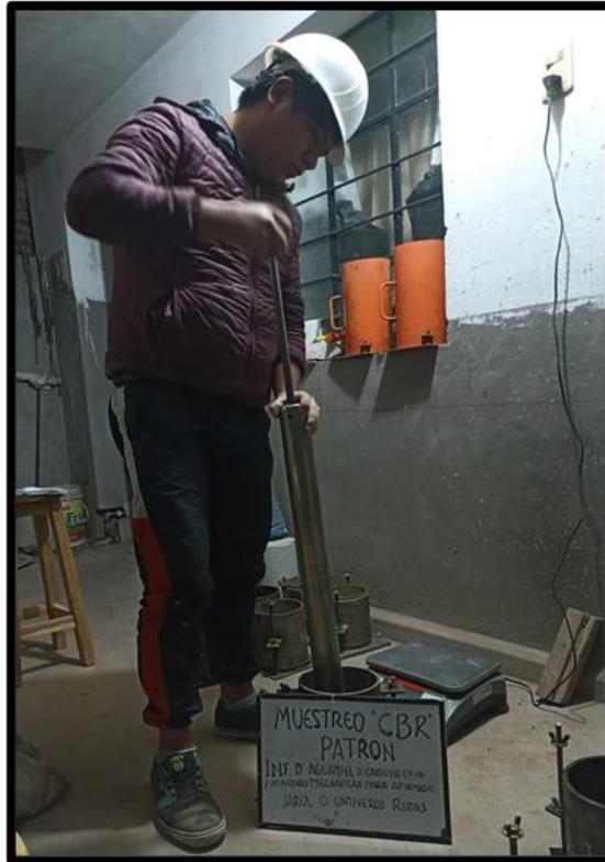
**Foto N° 11.** Compactación de la muestra patrón para el ensayo CBR.
