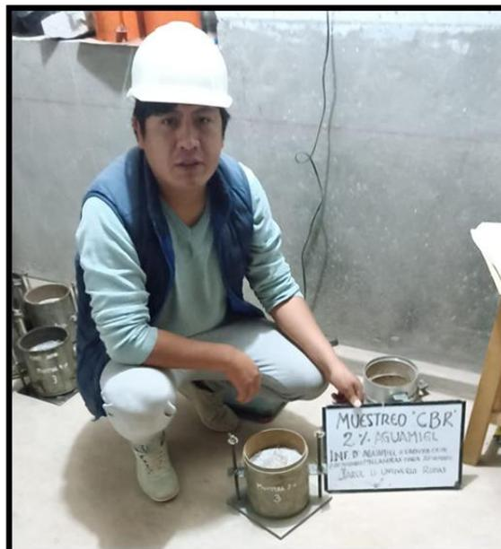
**Foto N° 14.** Muestreo y compactación del material con 2% de aguamiel de cabuya para el ensayo CBR.
