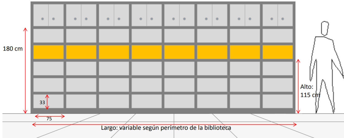
Figura 27: Criterio General y Referencial para la Elaboración de Mobiliario (Estantería Perimetral Madera).
