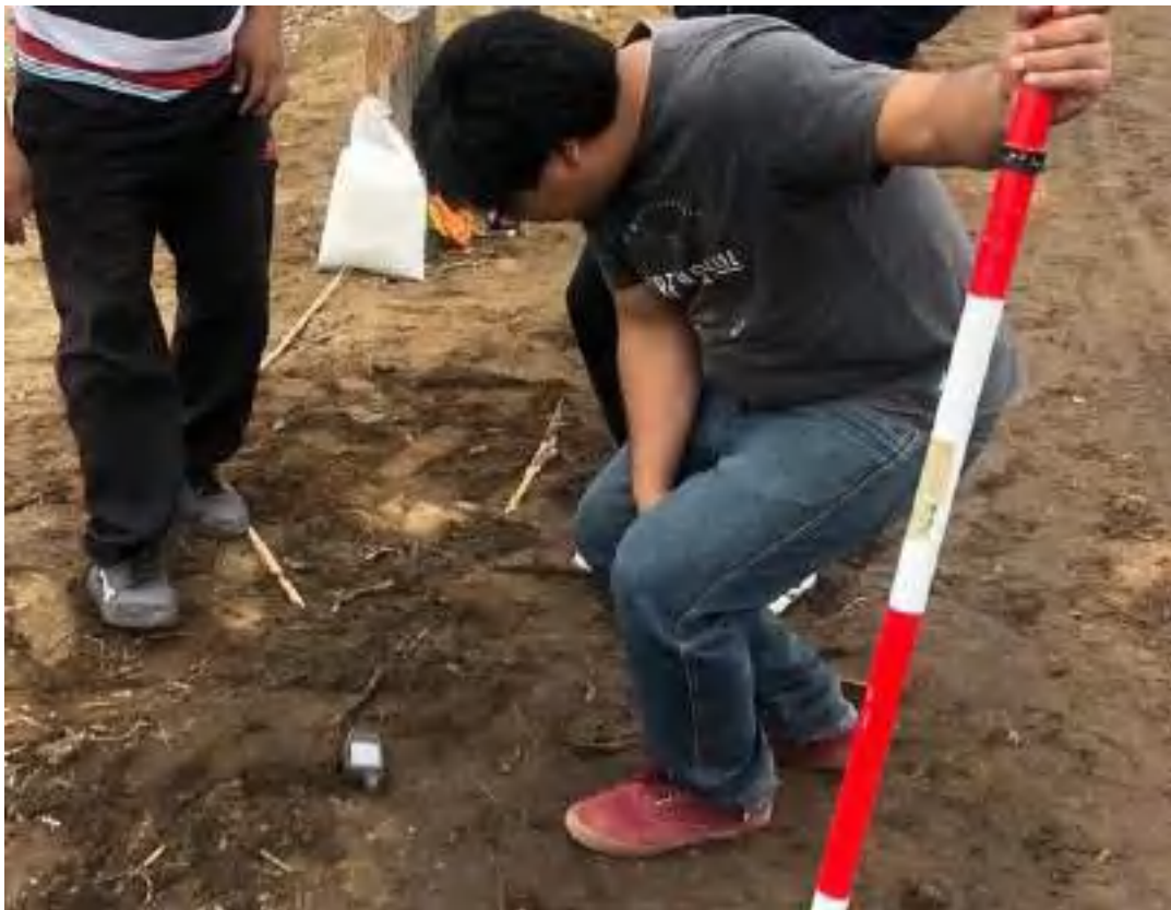
Figura 3. Toma del BM con GPS de la I.E.P.S. 10991 caserío Casa Blanca.
