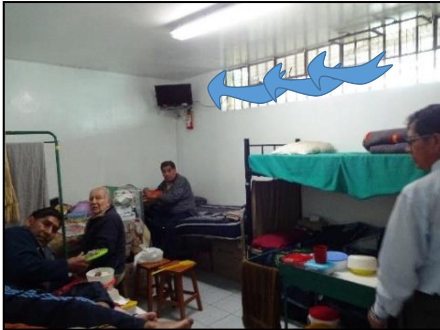
El área de internamiento sin ventilación cruzada, la norma a.050 art 6 nos muestra los ambientes incumplen con el aforo. Además la escala en comparación al número de ocupantes no contribuye en la ventilación del espacio.
