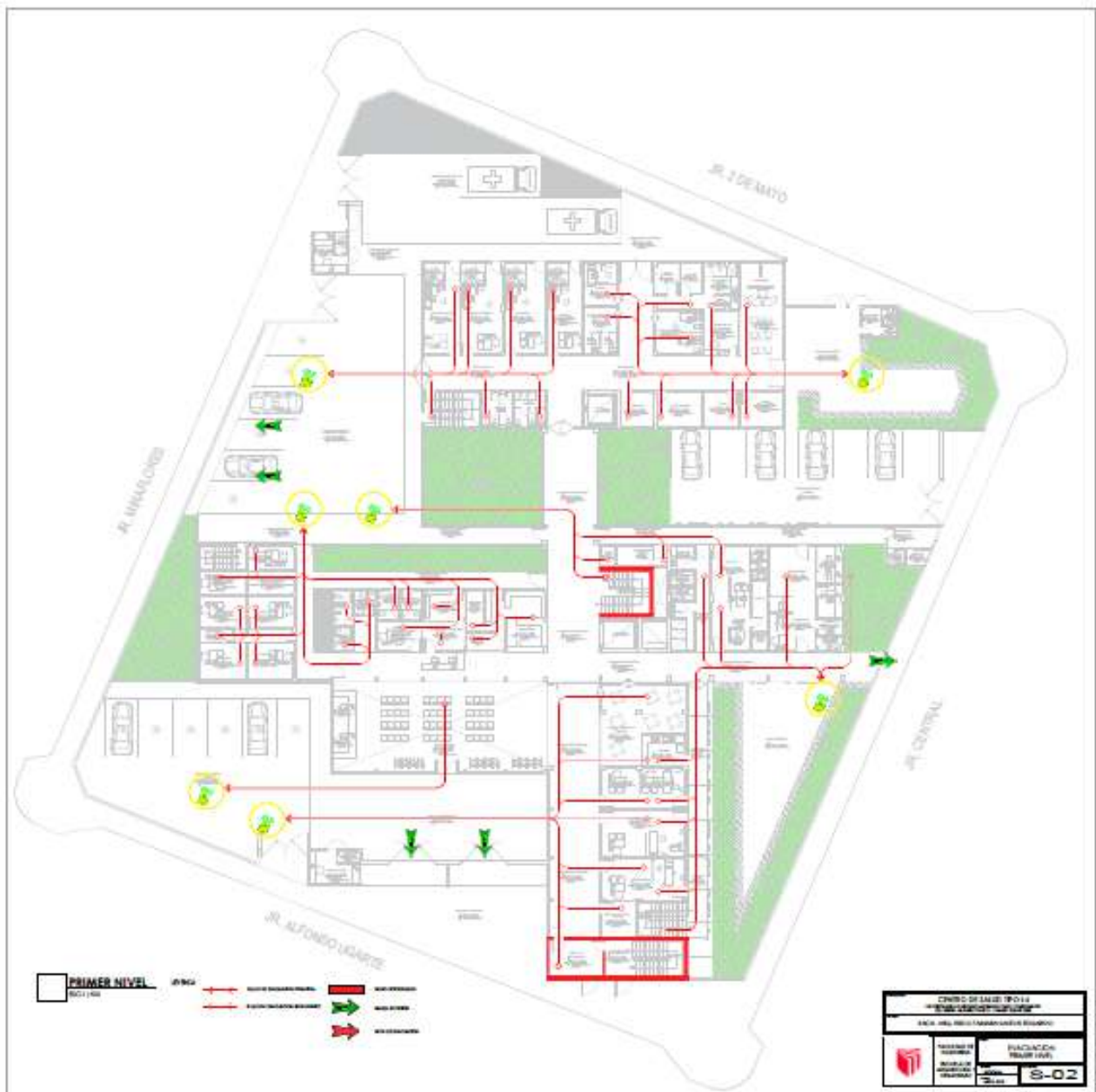
Figura 65: Plano de Evacuación-Primer Nivel.
