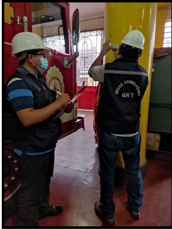
Figura 3: Ensayo de esclerometría
