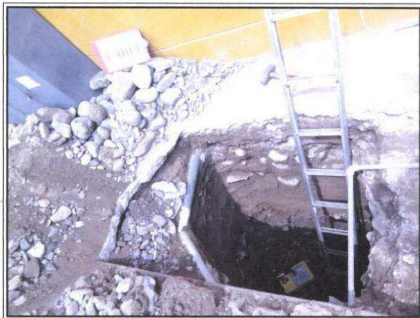
FOTO 7: Vista del ensayo de densidad In situ en la calicata C-003.
