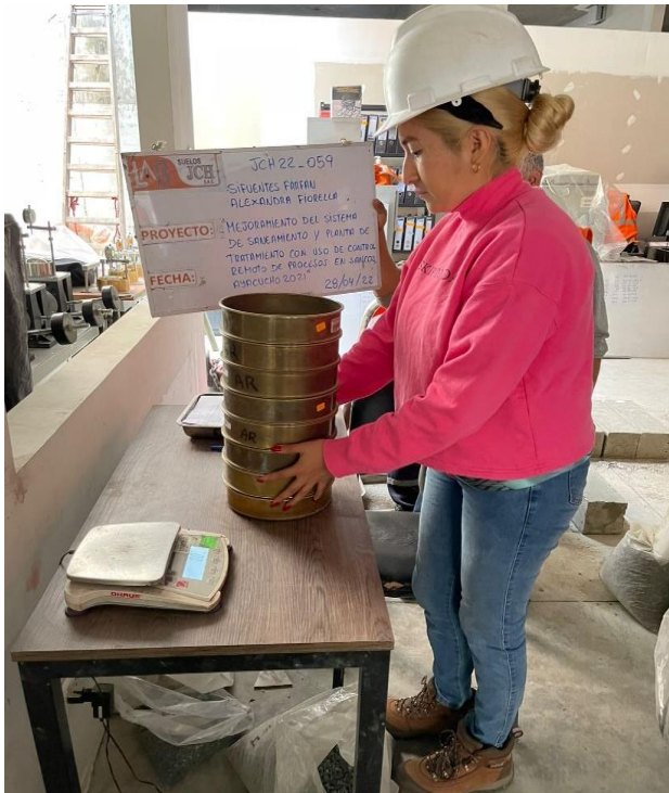
Foto 10. Cribado en Laboratorio compresion
