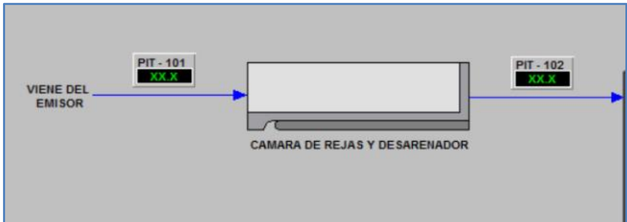
Figura 30. Flujo de la cámara de rejillas y desarenador.
