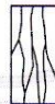
Tipo 3 Fisuras verticales encolumnadas a través de ambos extremos, conos no bien formados
