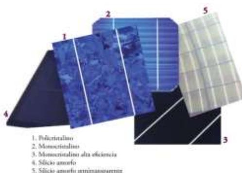
**Figura 3. Tipos de células fotovoltaicas**
