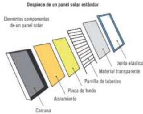
**Figura 4. Elementos componentes de un panel solar**
