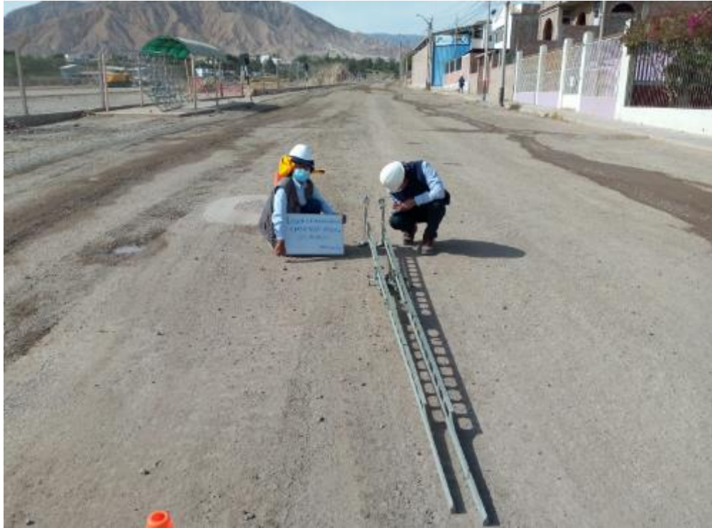
Figura 34. Ensayo de Viga Benkelman, Elaboración Propia.
