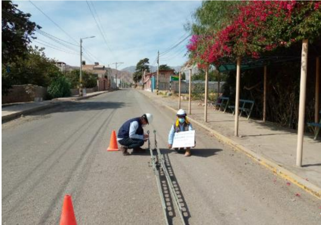
Figura 36. Ensayo de Viga Benkelman, Elaboración Propia.
