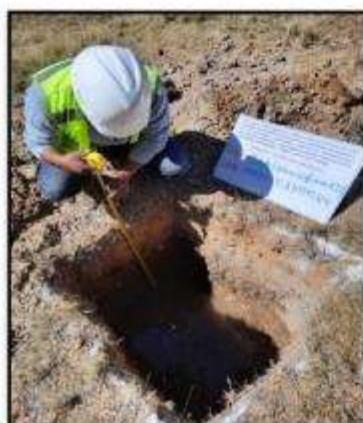
Figura 33 Registro del Nivel Freático Calicata 2
