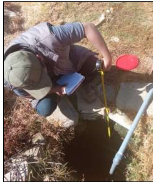
Toma de dato del pozo, cantidad de volumen de agua, abastecimiento y tiempo de recuperación.
