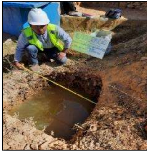
Figura 32 Registro del Nivel Freático Calicata N° 01
