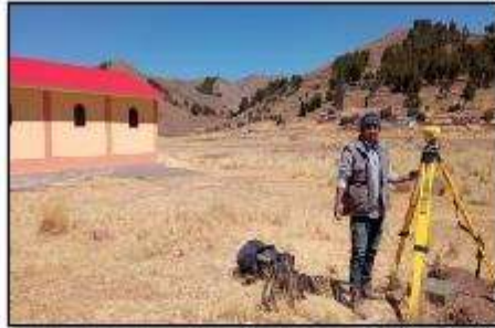
Imagen 01 e imagen 02. posicionamiento del GPS Diferencial en el punto de control PC-01 para enlace y ajuste de las coordenadas.
