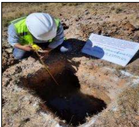
Figura 33 Registro del Nivel Freático Calicata 2
