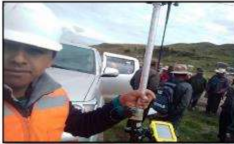
Imagen 14. levantamiento topográfico en el sector cucho Chacamarca con el ROVER y el Colector de Datos
