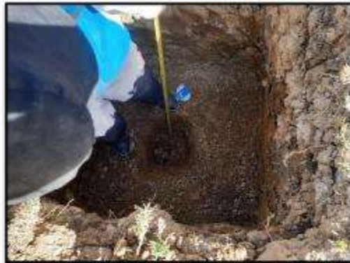
Análisis de prueba de filtración en la calita, para determinar el almacenamiento del suelo.
