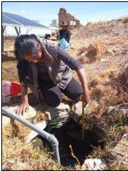
Toma de dato del pozo, cantidad de volumen de agua, abastecimiento y tiempo de recuperación.
