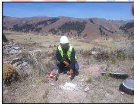
Imagen 03: Posicionamiento del GPS Diferencial en el punto de control PC-01 para el enlace y ajuste posterior ubicados en el sector cucho chacamarca de de la comunidad de huancho.
