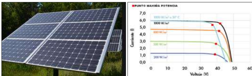
Nota: curva I-V, variación de temperatura de 25° -50°
