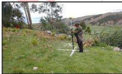
Imagen 16. Registro de la foto controles para levantamiento topográfico, con el dron, ROVER y el Colector de Datos.
