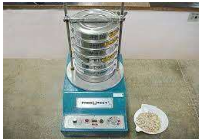
Figura 4: Equipo para el ensayo de granulometría
