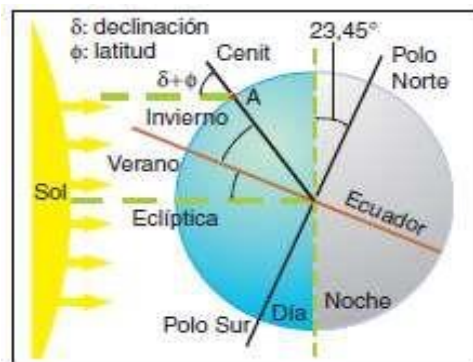
Figura 03: Posición de la tierra respecto del sol. (Fuente: Teoría de Módulos fotovoltaicos, 2 007)
