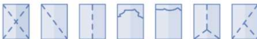
Figura 11. Tipos de fractura o falla al realizar el ensayo a la compresión.
