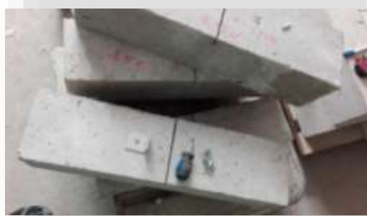
Ensayo de resistencia a la flexión
