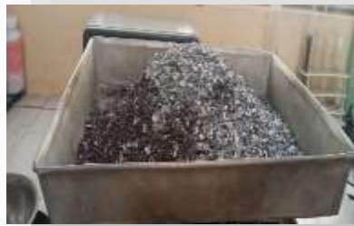
Molido de carcasas de plástico para adición
