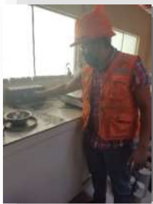
Secado al horno de los agregados
