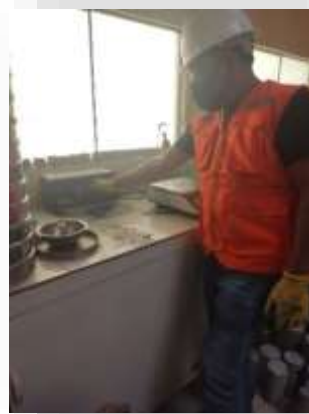
Secado al horno de los agregados
