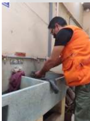
Lavado de los agregados
