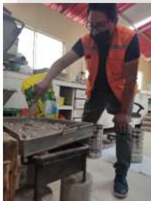
Lavado de los agregados
