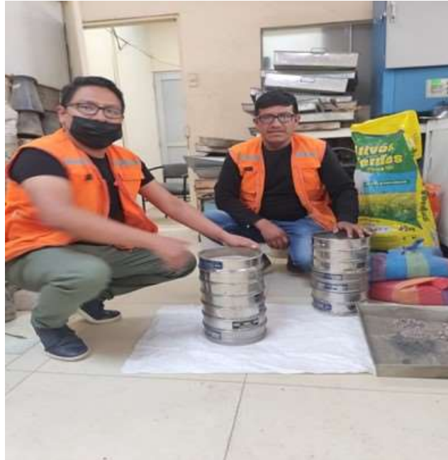
Figura 19. Tamices para análisis granulométrico
