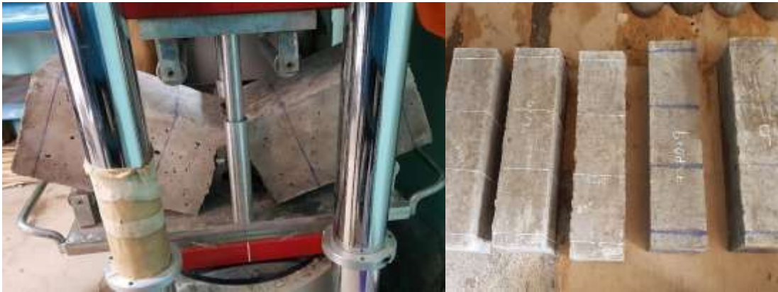
Figura 56. Probetas rotas en resistencia en flexión.
