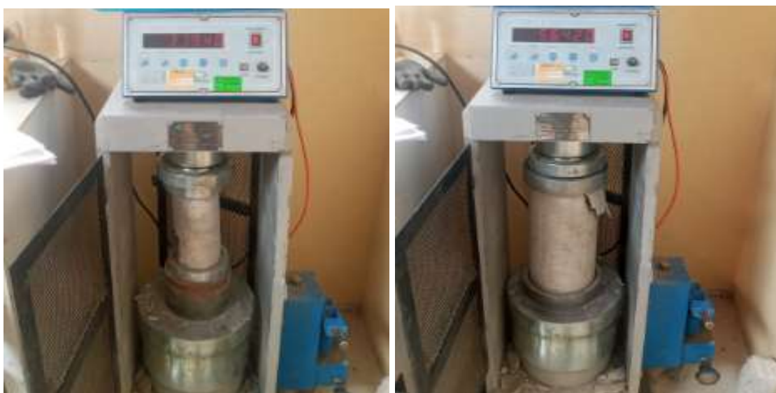
Figura 27. Probetas sometidas a compresión
