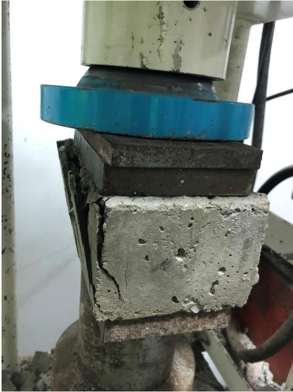
Figura: Ensayo de resistencia a compresión.
