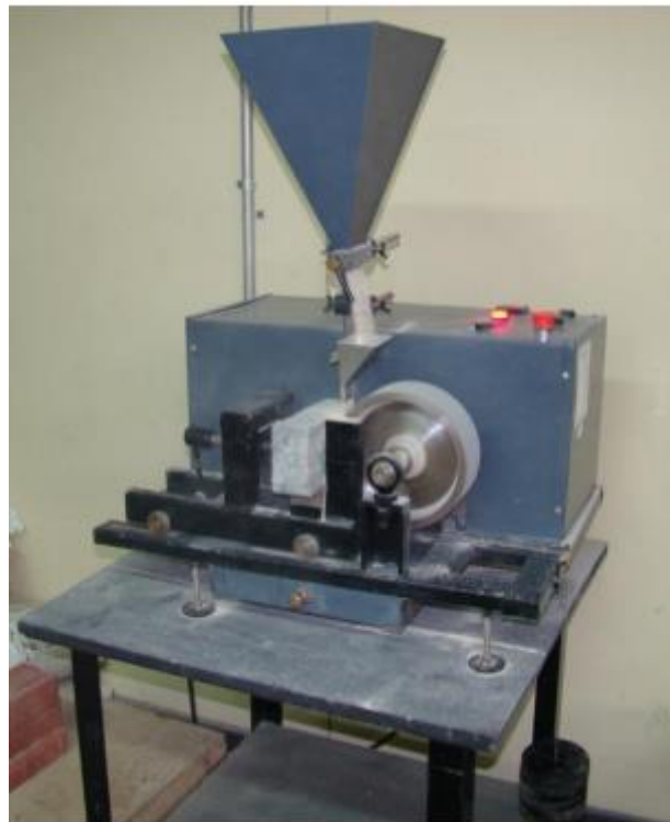
Figura: Ensayo resistencia al desgaste por abrasión.
