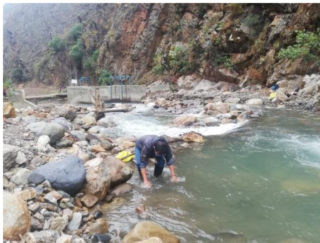
Foto 3: Extracción de muestra del río para determinar la medida de los sólidos suspendidos que arrastra el río
