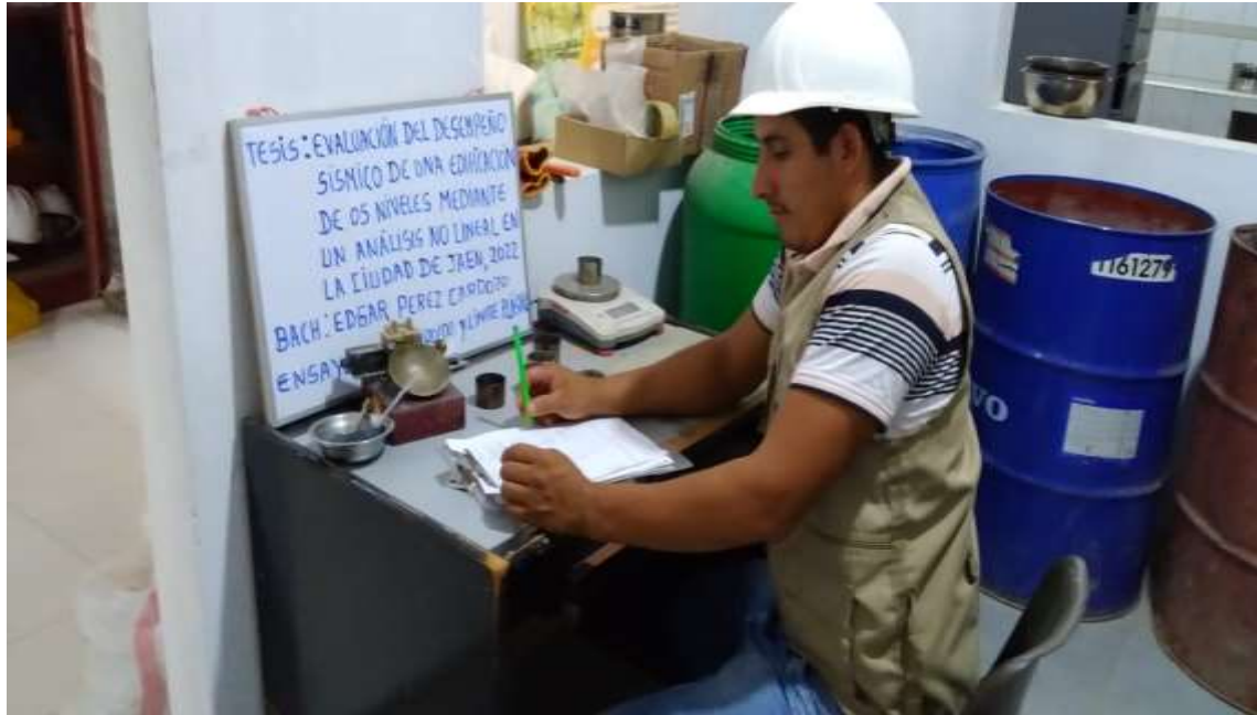
IMAGEN 05: Se realiza el ensayo de limite liquido
