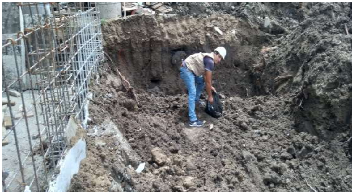
IMAGEN 02: Se empieza a sacar la muestra del estrato del suelo
