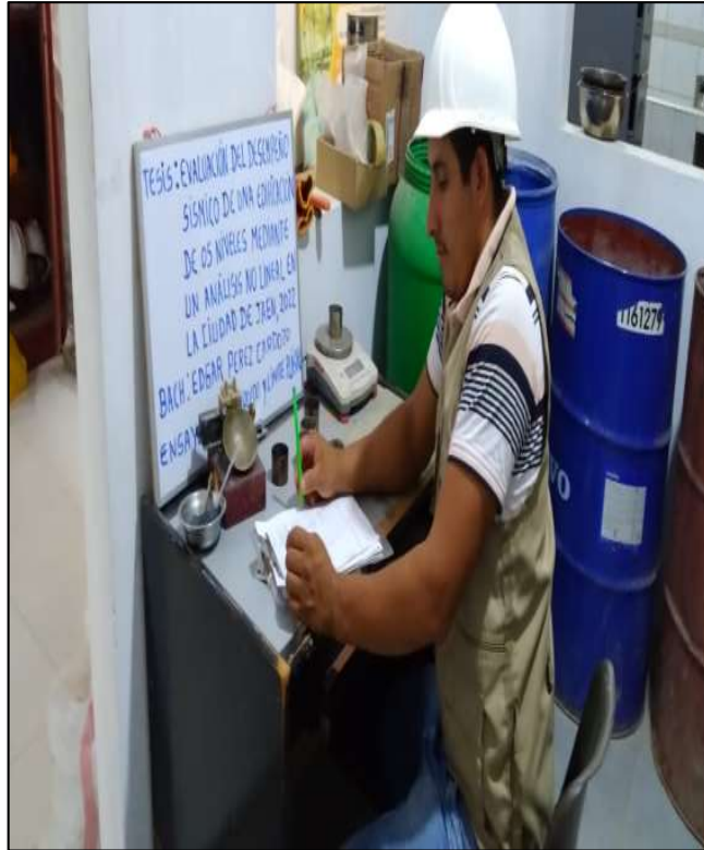
Figura 5 Se Realiza el ensayo limite líquido y limite plástico
