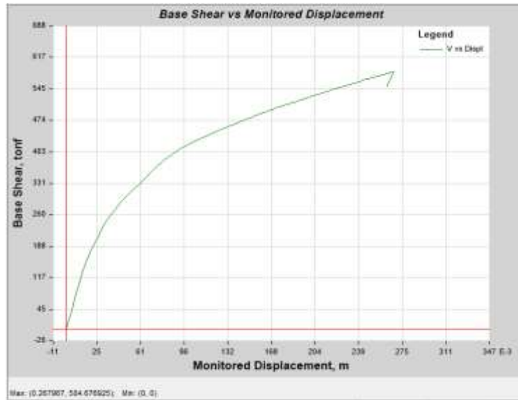
Figura 44 Curva de capacidad – Pushover en “X”
