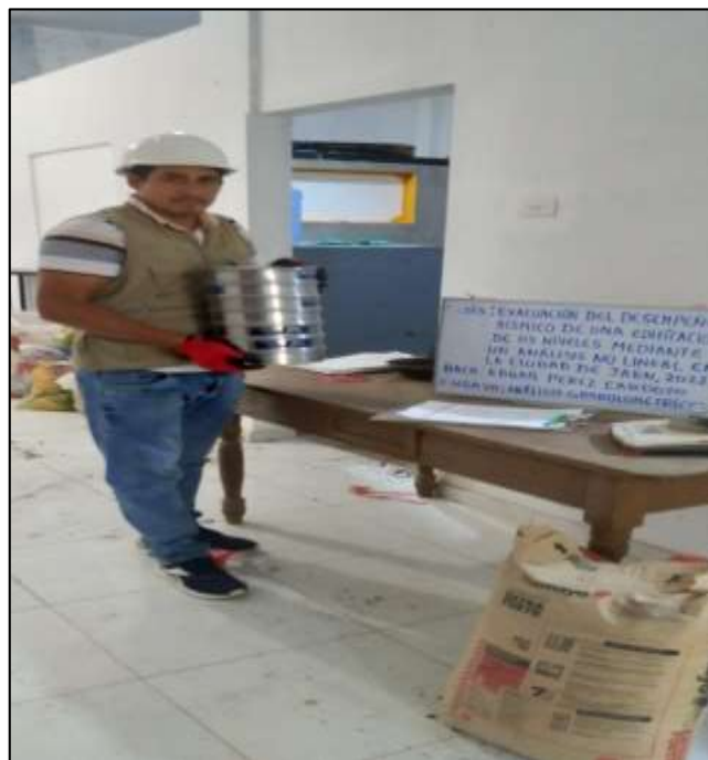
Figura 4 Se realiza el ensayo de análisis granulométrico
