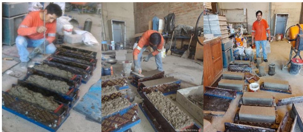
Proceso de vaciada, frotachado y desmoldado de las vigas.
