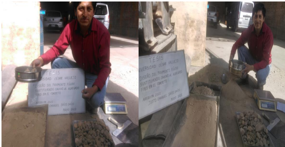
Preparación de suelo para proctor y CBR
