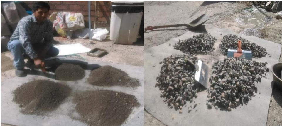
Cuarteo de la arena gruesa y el agregado grueso
