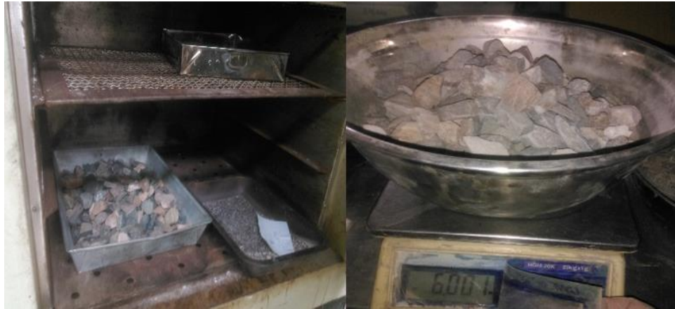
Agregado fino y grueso por 24 horas para peso específico
