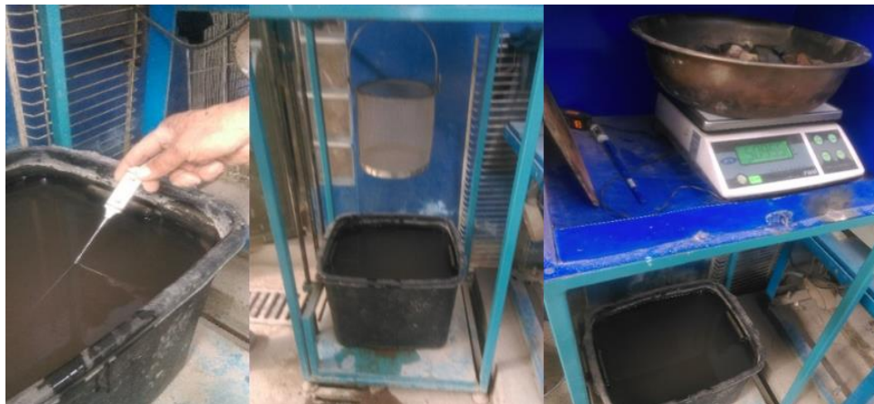
Medición de temperatura del agua para ensayo de peso específico aparente y masa de la muestra en estado sumergido
