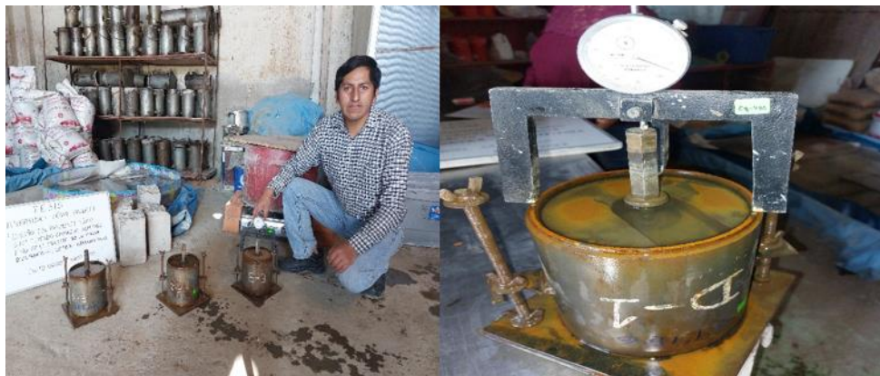
Moldes para medir la expansión
