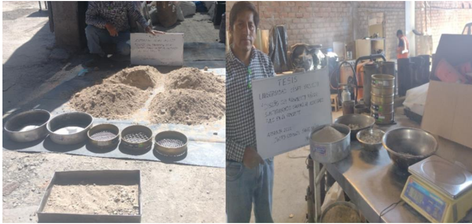
Preparación del suelo sustituyendo el reteniendo de la malla 3/4"
