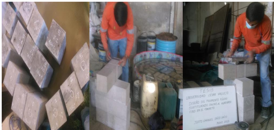
Proceso de curado, trazo de los tercios y verificación de alabeos
