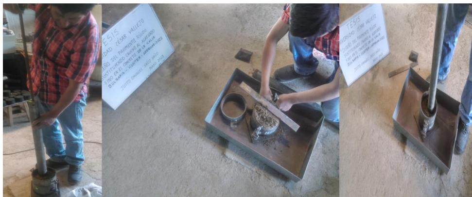
Compactación de suelo para CBR
