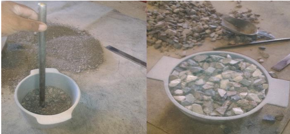
Varillado y enrazado de la grava para calcular peso unitario
