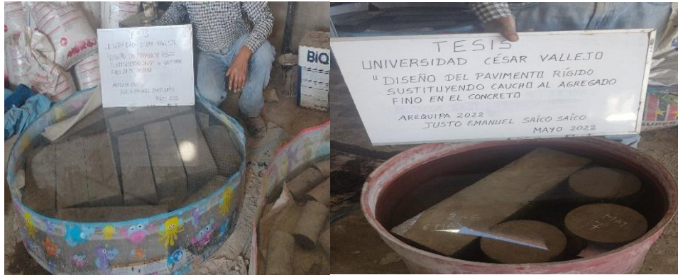
Curado de vigas y probetas cilíndricas
