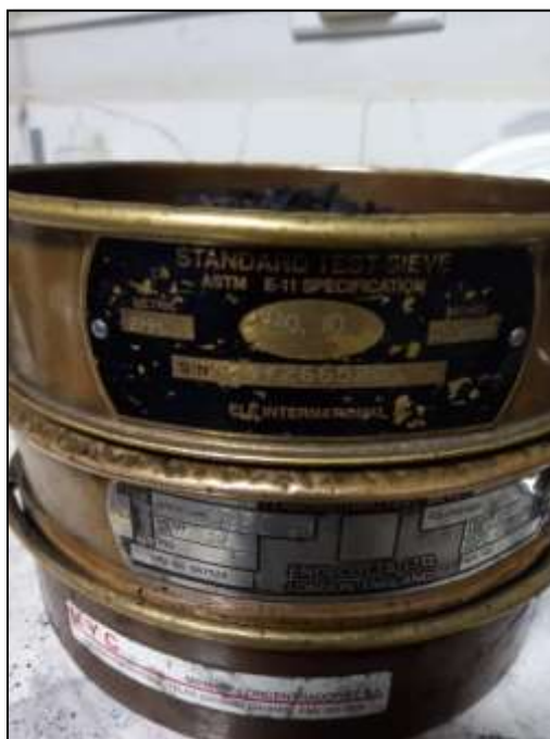
Figura N°17: Se procede a pasar la muestra triturada por el tamiz N°10 y N°20
