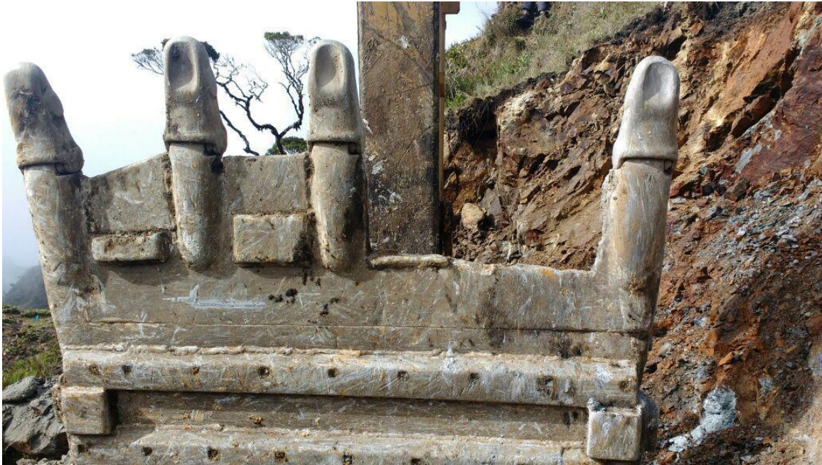
Figura 23: rotura de adapter central y uña.
