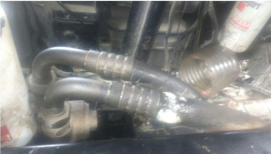
Figura 28: Fuga de aceite hidráulico.
