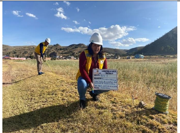
Figura 8: Sondaje eléctrico vertical (SEV 1) tendido de cable para la obtención de datos
