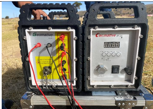
Figura 5: Equipo para realizar las lecturas de sondaje eléctrico vertical.
