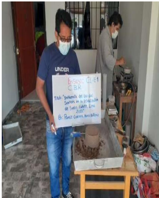
Ensayo de C.B.R. para calicata n°03
