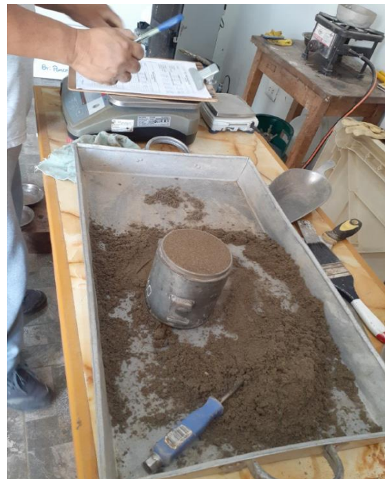
Pesado de cilindro de Proctor para hallar en grado de compactación.
