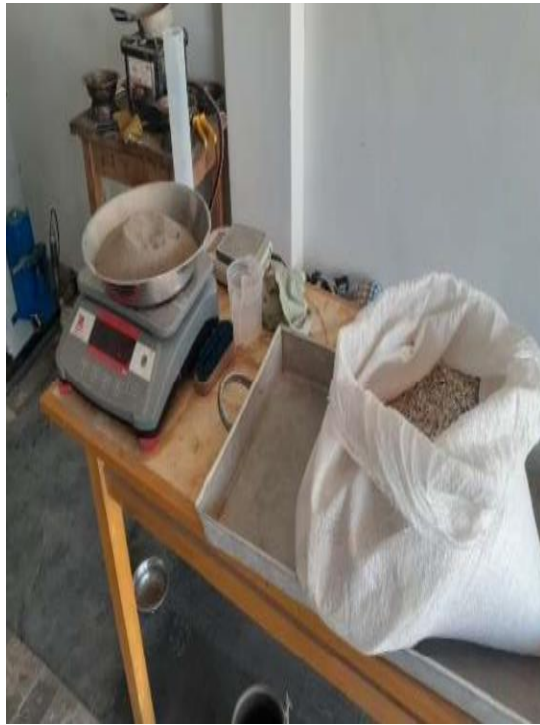
Dosificaciones del Scallops para agregar al suelo natural
