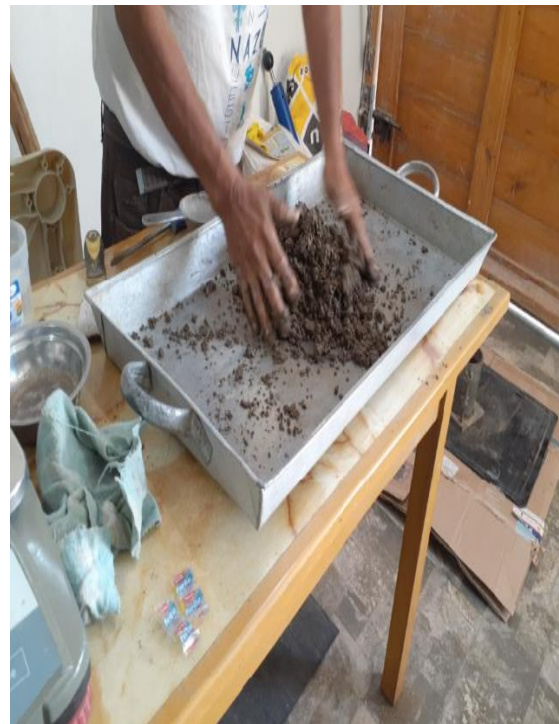
Dosificación de agua en suelo natural para ensayo de Proctor
