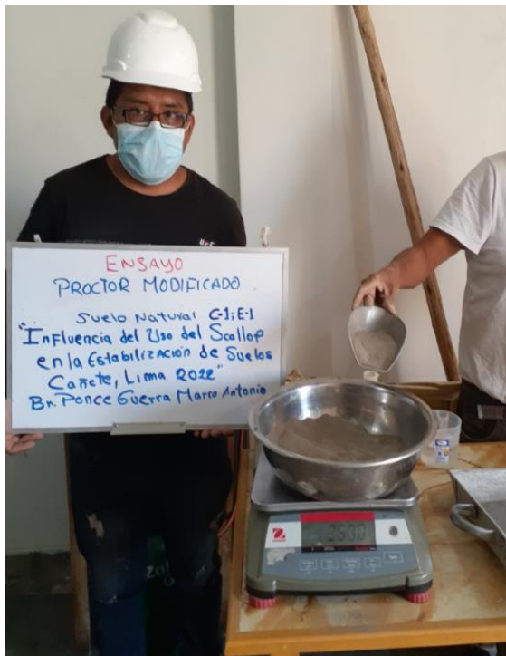
Ensayo de Proctor modificado para suelo natural, calicata n°01
