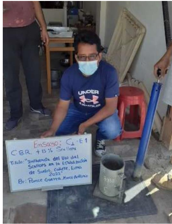
Ensayo C.B.R. con dosificación 15% de Scallops con suelo de calicata n°01
