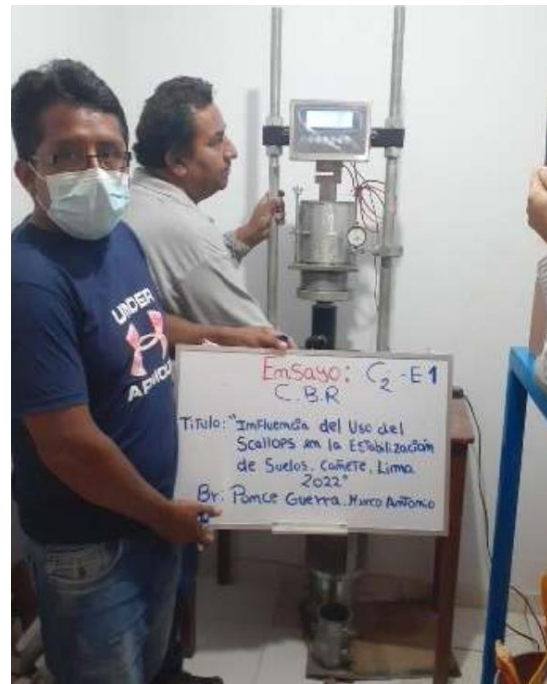
Ensayo de C.B.R. para calicata n°02
