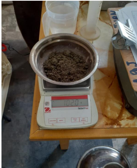
Pesado de muestra para luego llevar al horno para hallar el contenido de humedad
