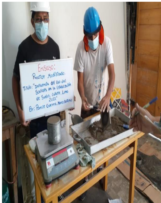
Ensayo de Proctor modificado para suelo natural, calicata n°03
