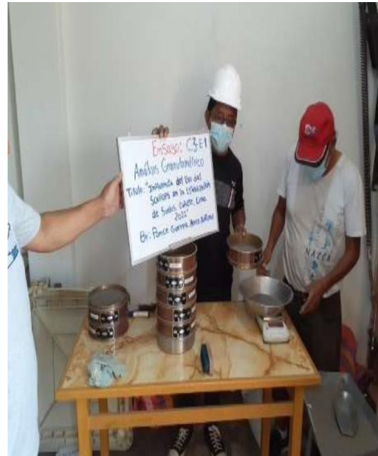
Pesado de muestras de suelo calicata n°03 retenidas en tamiz.
