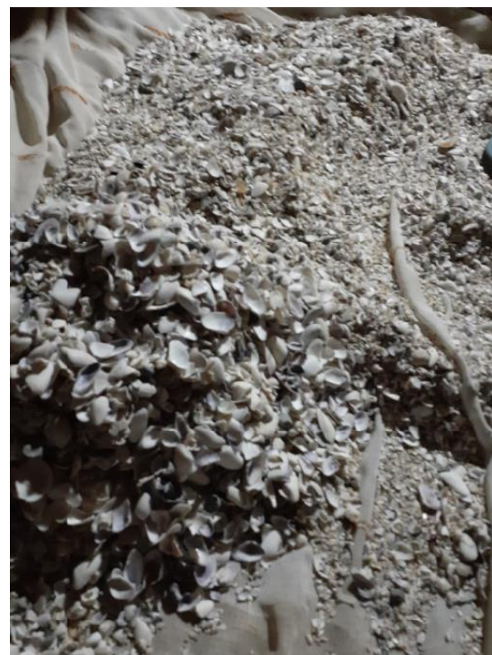
Trituración del Scallop para las distintas dosificaciones
