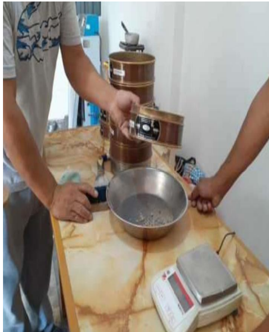
Pesado de muestras retenidas en tamiz, suelo con Scallops
