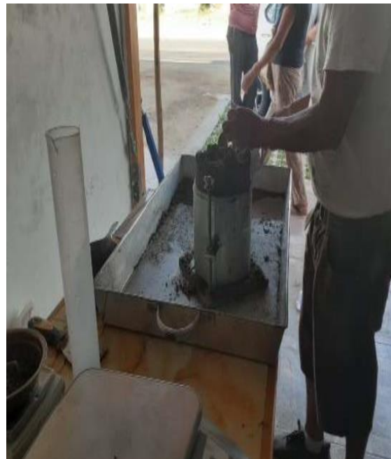
Retiro de collarin de molde de C.B.R. para seguidamente pesar la muestra
