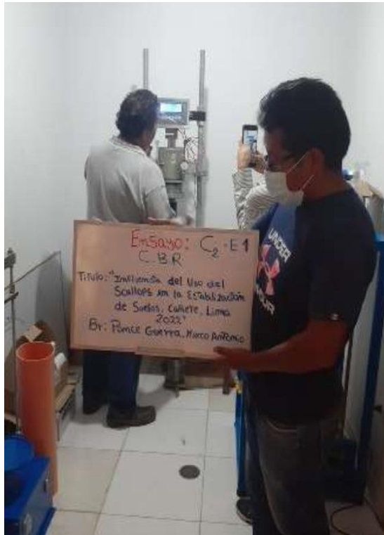
Ensayo de C.B.R. para calicata n°02
