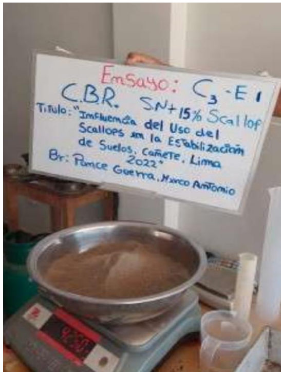
Scallops al 15% en dosificación con respecto al suelo natural de calicata n°03
