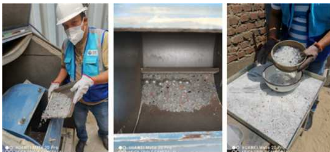
Figura N° 7 Proceso de molienda del vidrio reciclado.
