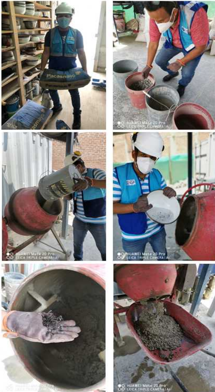
Figura N° 9 Elaboración de concreto para moldes a ensayar.
