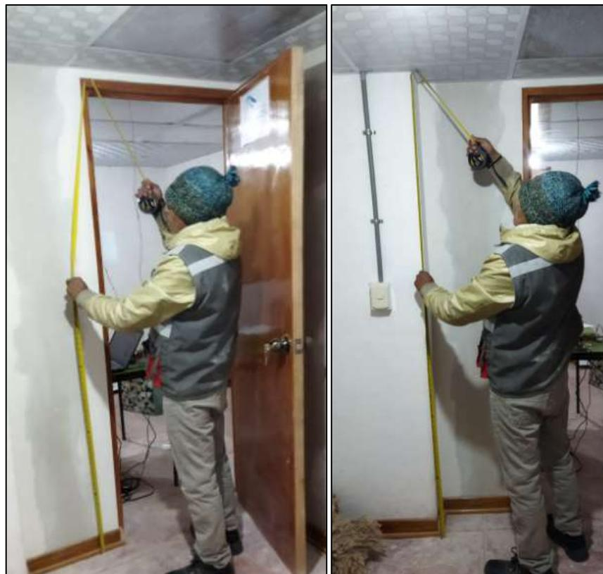
**Figura 51.** Medición con flexómetro la altura al cielorraso
