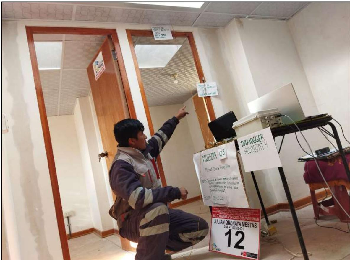
**Figura 68.** Medición de temperatura y humedad relativa en el interior de la vivienda y espacio sobre cielorraso.
