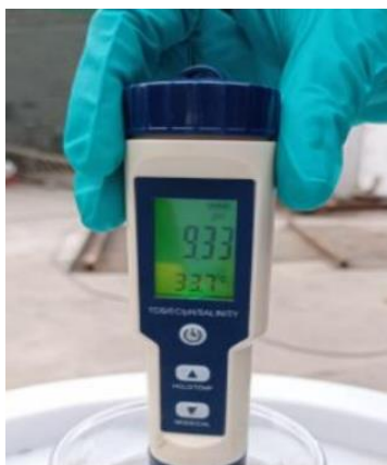
Figura 4. Equipo de Multiparámetro
