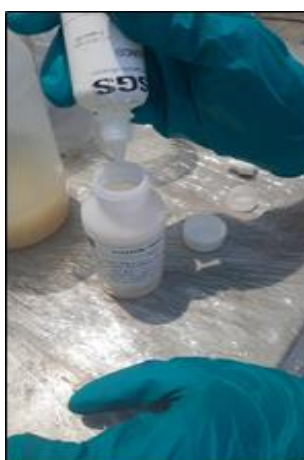
Figura 17. Adición de químicos para preservar las muestras
