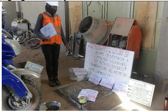
Fotografía 8. Se muestra los materiales cemento, agregado grueso, agregado fino, azufre y agua para el mezclado en mezcladora de concreto tipo trompo.
