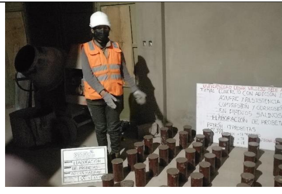
Fotografía 16. Se muestra la elaboración total de los especímenes de concreto más adición de azufre.
