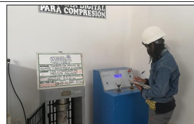
Fotografía 26. Se realizó la rotura a compresión de especímenes de 10 x 20 cm.
