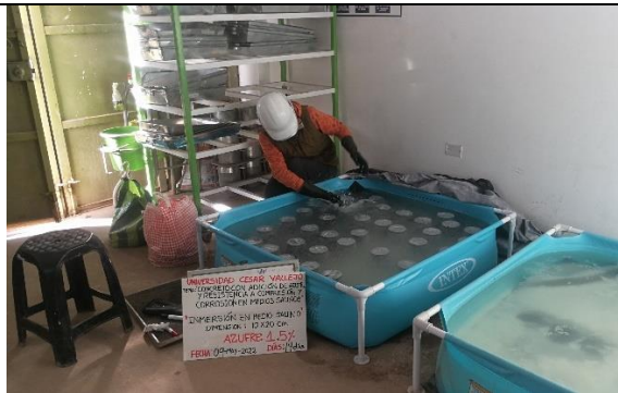
Fotografía 19. Se muestra el curado con solución de cloruro de sodio.
