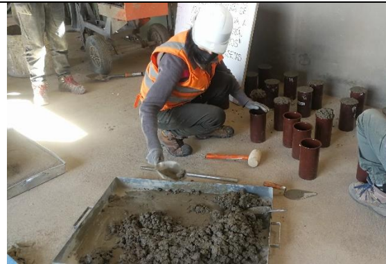
Fotografía 13. Se observa la elaboración de los especímenes de concreto con adición de azufre.
