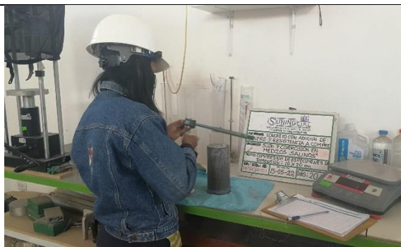
Fotografía 21. Se observa la medición de los especímenes para posterior rotura a compresión.
