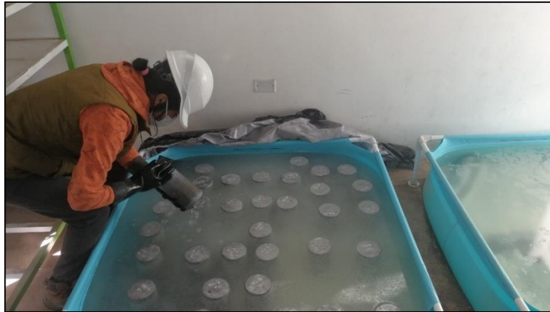
Figura 13. Curado de briquetas en posas.
