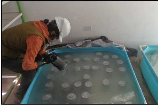
Fotografía 17. Se muestra el momento del curado de los especímenes de concreto.
