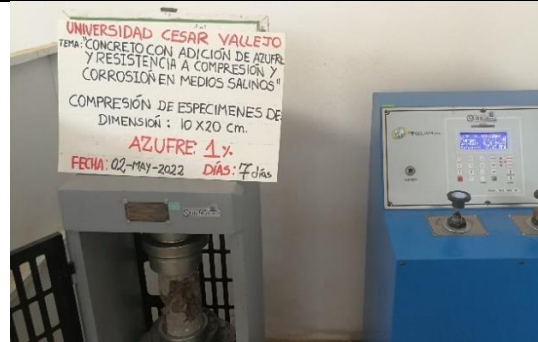
Fotografía 23. Se realizó la rotura a compresión de especímenes de 10 x 20 cm.
