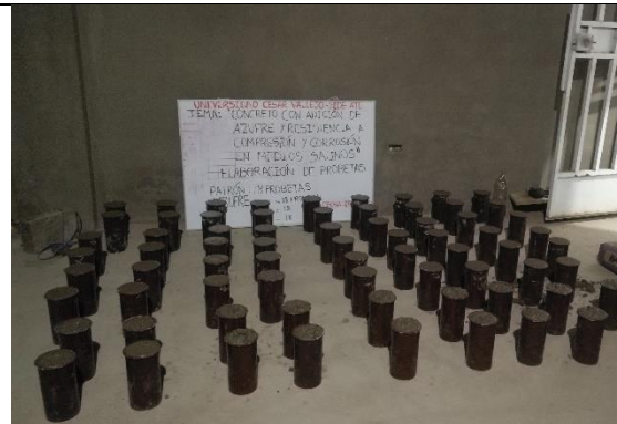
Fotografía 15. Se muestra la elaboración total de los especímenes de concreto más adición de azufre.
