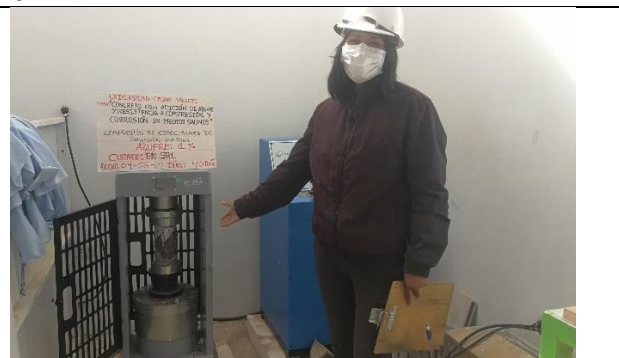
Fotografía 26. Se realizó la rotura a compresión de especímenes de 10 x 20 cm.
