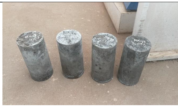
Fotografía 22. Se observa los especímenes para posterior rotura a compresión.
