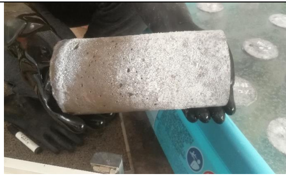
Fotografía 20. Se muestra un espécimen con un deterioro debido a ataques de sales producto del curado con sal.
