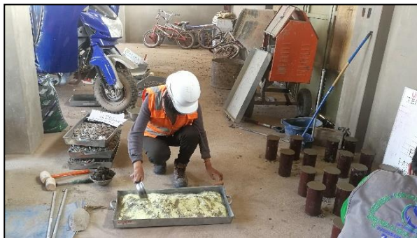
Figura 10. Mezcla de cemento con Azufre en polvo.
