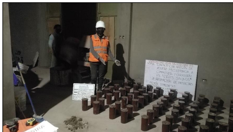
Figura 12. Briquetas para curado normal y en medio salino.
