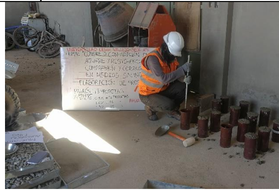
Fotografía 14. Se observa la elaboración de los especímenes de concreto con adición de azufre.
