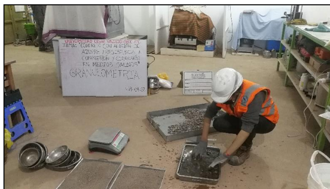
Figura 7. Ensayo de granulometría
