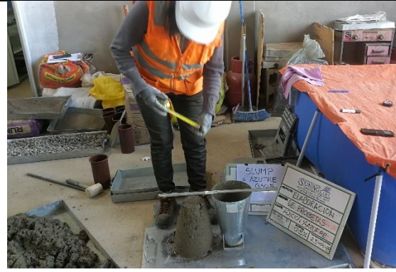
Fotografía 12. Se realizó la medición del asentamiento del ensayo de slump.
