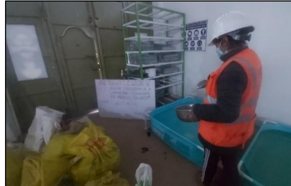
Fotografía 18. Se muestra el momento del curado de los especímenes de concreto.
