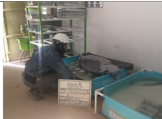
Fotografía 23. Se realizó la rotura a compresión de especímenes de 10 x 20 cm.
