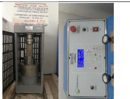
Fotografía 27. Se observa la rotura de concreto a compresión.
