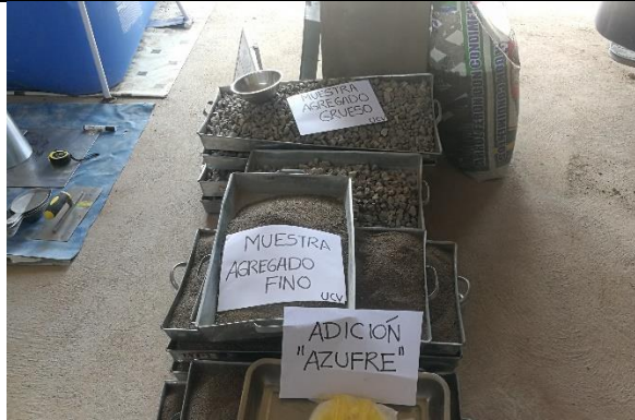
Fotografía 6. Se realizo el peso correspondiente de los materiales a usar como es: cemento, agregado grueso, agregado fino, y azufre.
