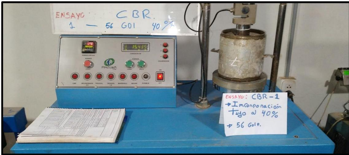
DESCRIPCION: Ensayo de penetración del CBR para un 40 % de tufo volcánico.
