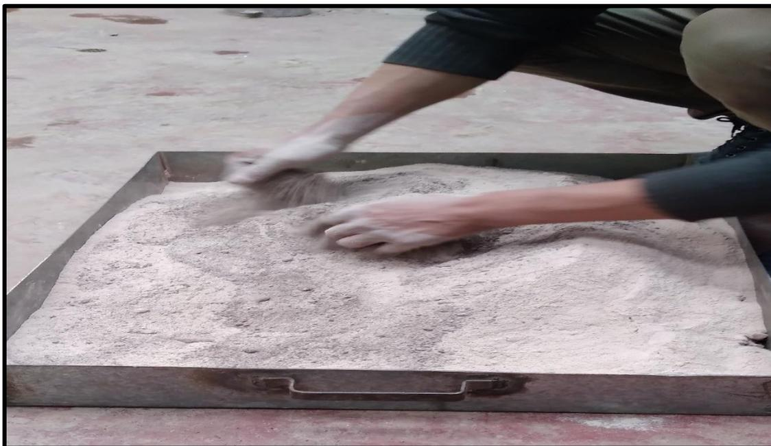
**DESCRIPCION:** Proceso de mezclado de tufo volcánico y suelo natural con la dosificación de 40 % de tufo y 21 kg de material este proceso se repite para el porcentaje 15 % y 8%.
