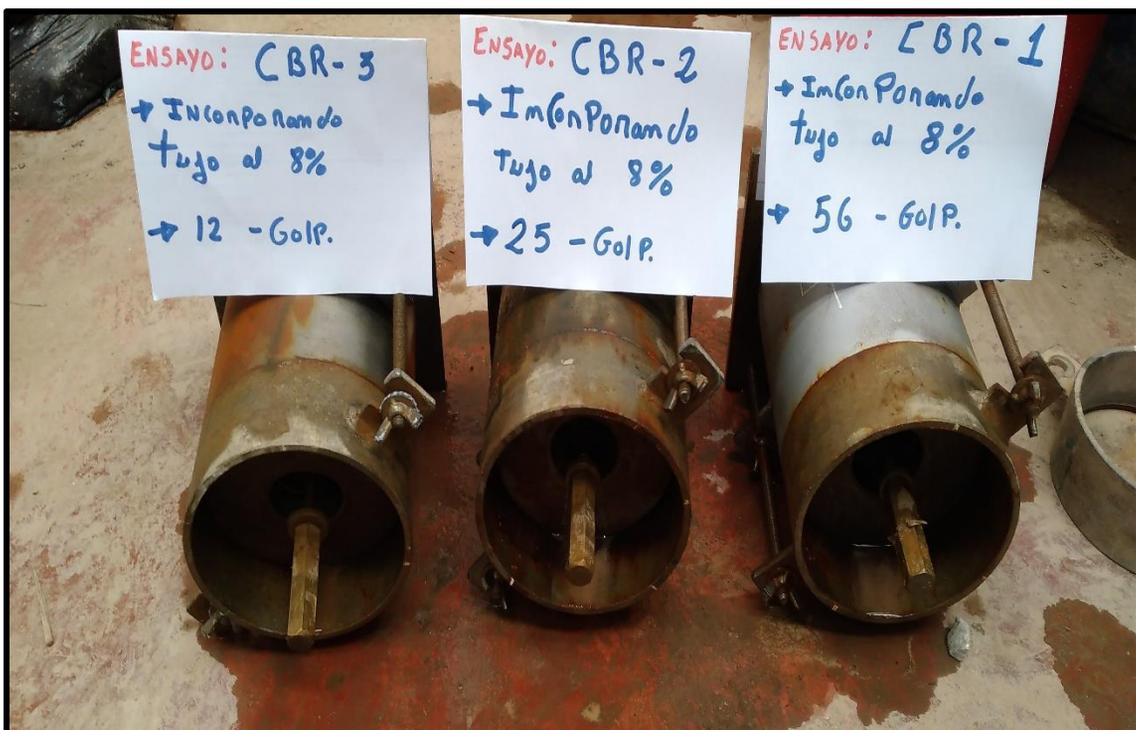
DESCRIPCION: Ensayo de penetración del CBR con 8 % de tufo volcánico.
