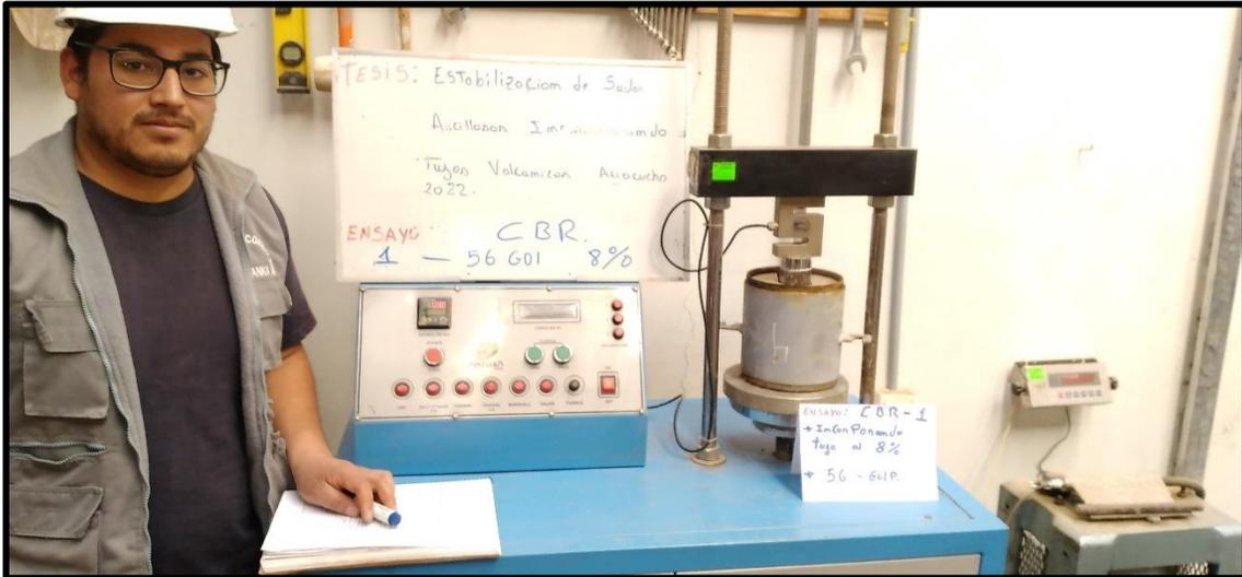
**DESCRIPCION:** Ensayo de penetración del CBR para un 8 % de tufo volcánico.
