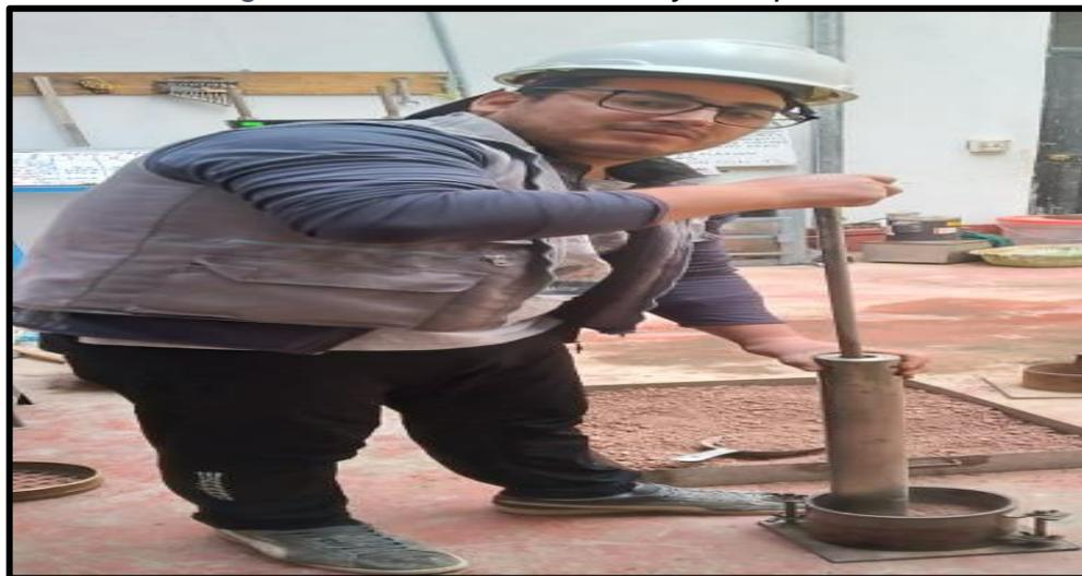
Fuente: ensayos de laboratorio FAMI del proctor.
