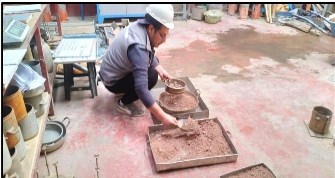
**DESCRIPCION:** Tamizado del material de la calicata N° 02 con la malla  $\frac{3}{4}$  para el Proctor y el CBR, este proceso se repite para los demás ensayos.
