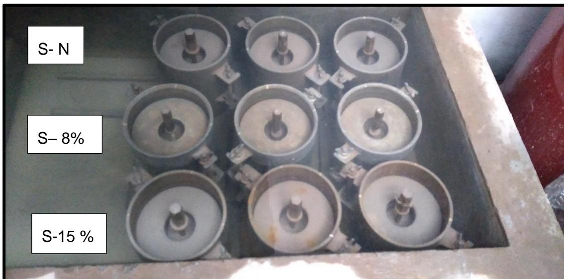
**DESCRIPCION:** En la presente imagen se aprecia los ensayos que se realizaron para los CBR ,de un suelo natural y luego el segundo ensayo a un 8% y el ultimo a 15 % de tufo volcánico esta .
