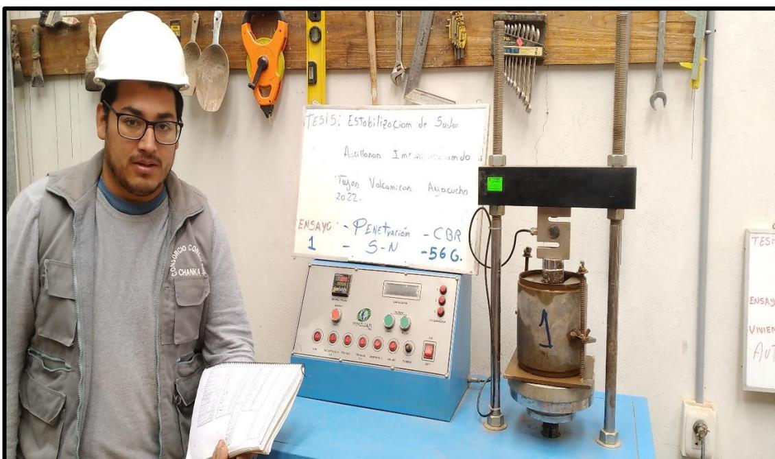
**DESCRIPCION:** Ensayo de penetración del CBR para suelo natural todo esto se repite para los 12 ensayos.
