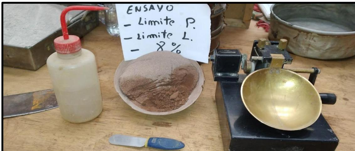
**DESCRIPCION:** Ensayo de Limite Liquido y Limite Plastico agregando 8 % de tufo volcanico.
