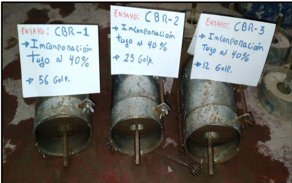
DESCRIPCION: Ensayo de penetración del CBR con 40 % de tufo volcánico.
