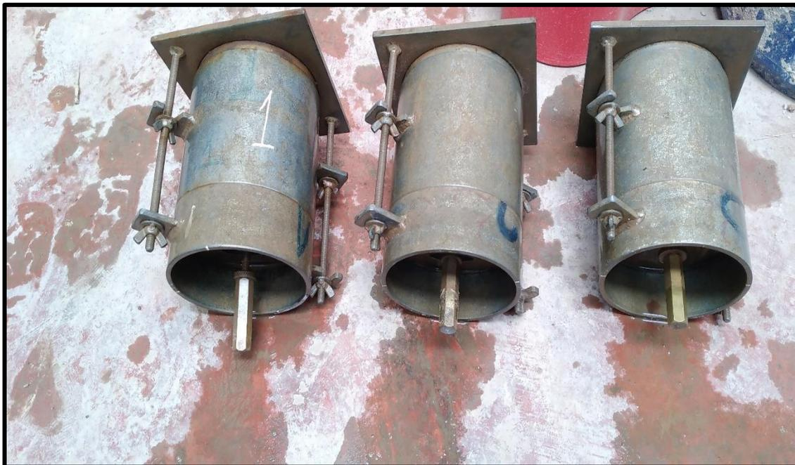
**DESCRIPCION:** Ensayo de penetración del CBR para suelo natural.
