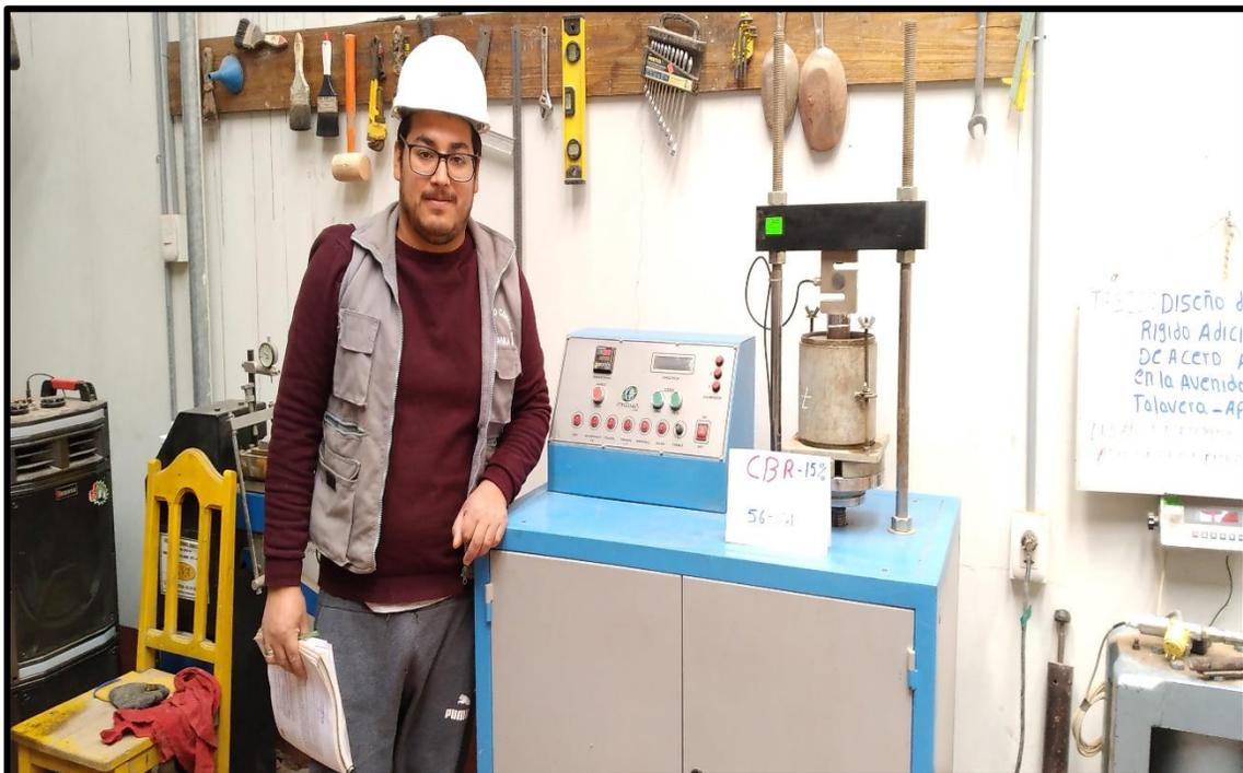
**DESCRIPCION:** Ensayo de penetración del CBR para un 15 % de tufo volcánico.
