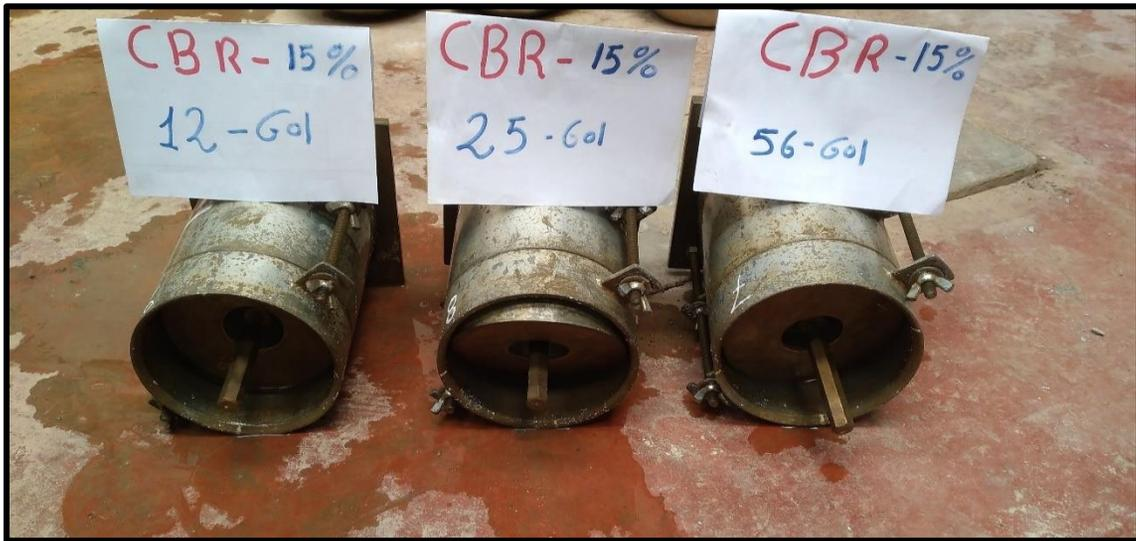
**DESCRIPCION:** Ensayo de penetración del CBR con 15 % de tufo volcánico.
