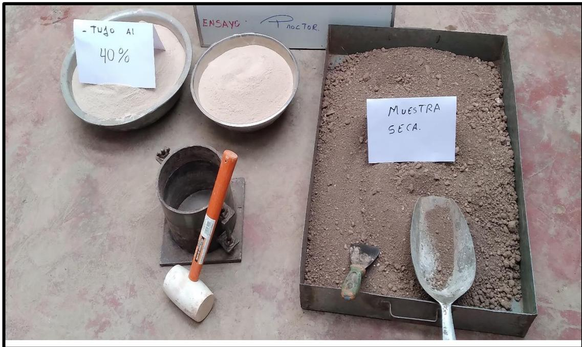
**DESCRIPCION:** Ensayo de CBR con la dosificación de 40 % de tufo y 21 kg de material este proceso se repite para el porcentaje 15 % y 8%.
