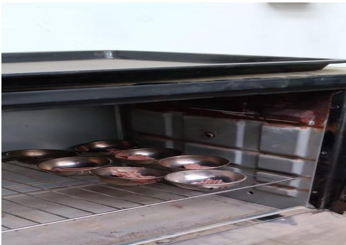
**DESCRIPCION:** Ensayo de Limite Liquido y Limite Plastico agregando 8 % de tufo volcanico.
