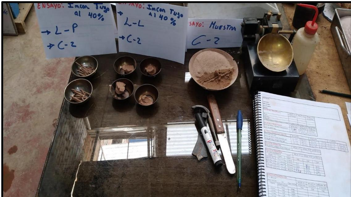
**DESCRIPCION:** Ensayo de Limite Liquido y Limite Plástico agregando 40 % de tufo volcánico.
