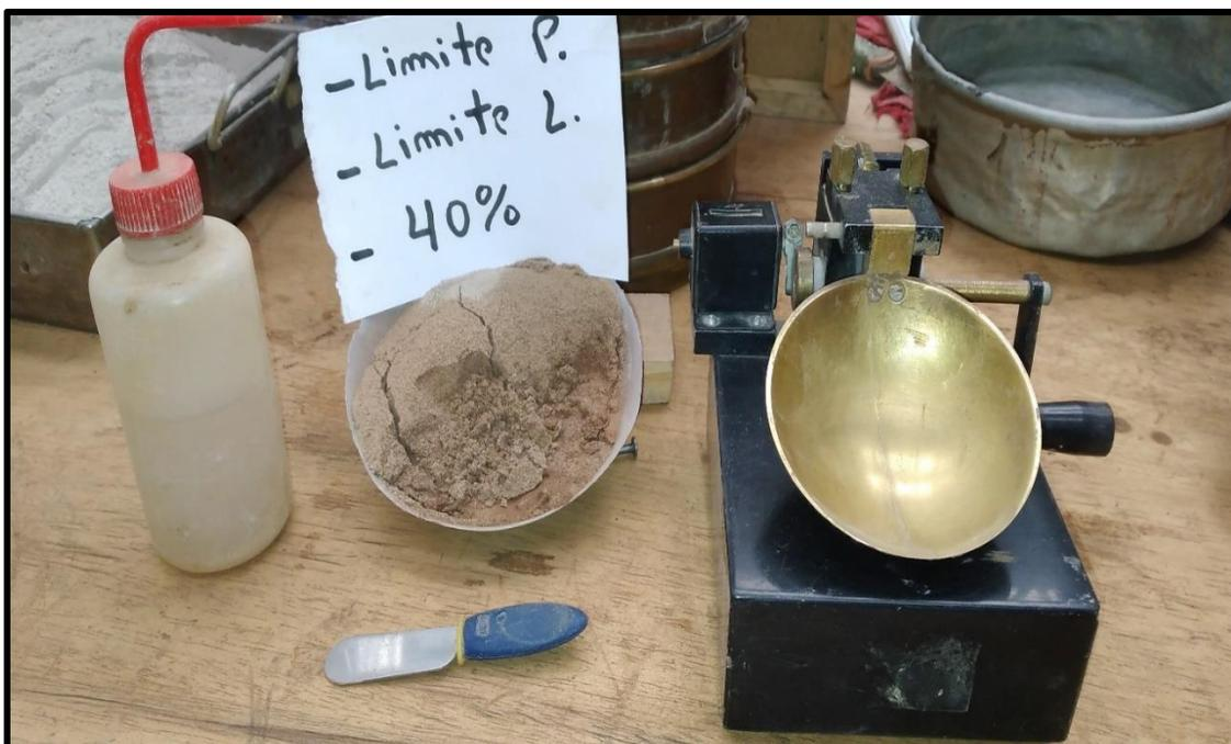
**DESCRIPCION:** Ensayo de Limite Liquido y Limite Plástico agregando 40 % de tufo volcánico.
