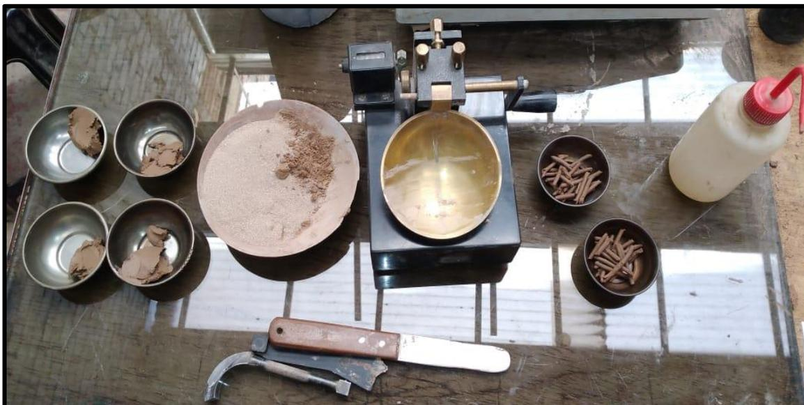
**DESCRIPCION:** Ensayo de Limite Liquido y Limite Plástico agregando 15 % de tufo volcánico.
