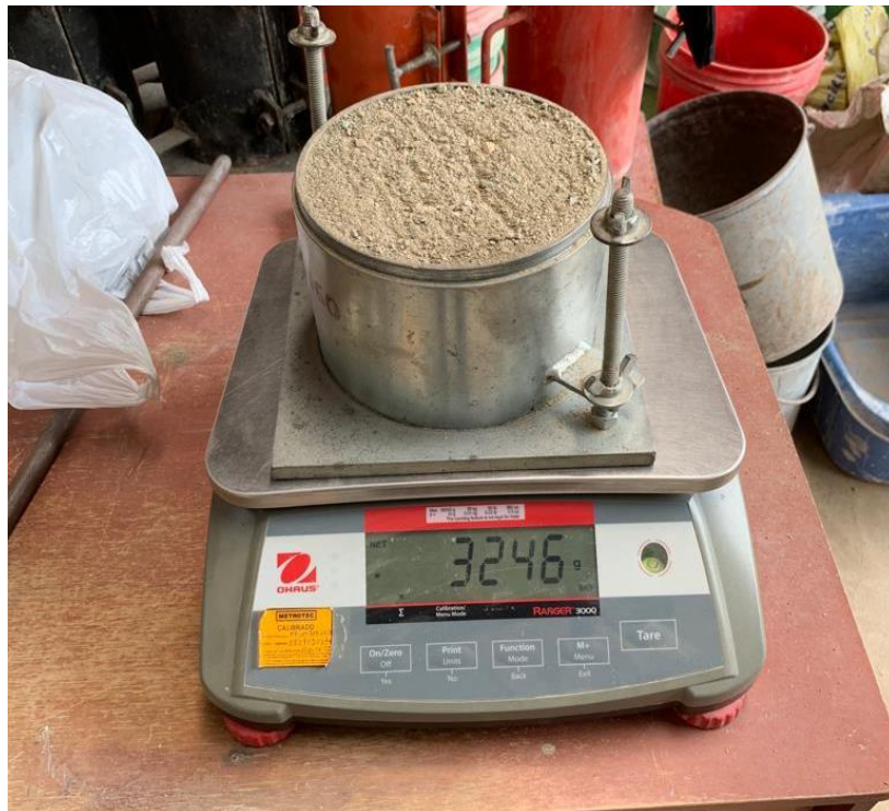
Foto 8. Peso de los agregados
