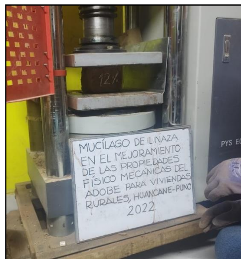
Figura 33: Resistencia a compresión 12%
