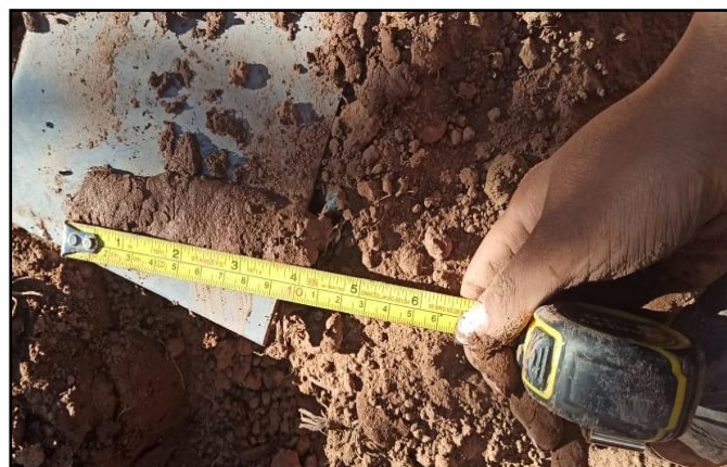
Figura 13: Prueba cinta de barro
