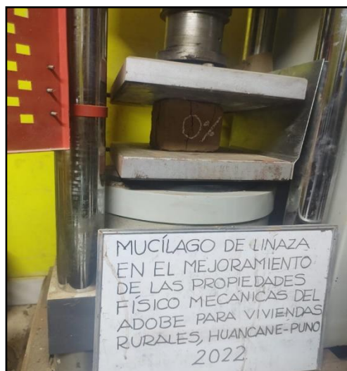
Figura 32: Resistencia a compresión 0%
