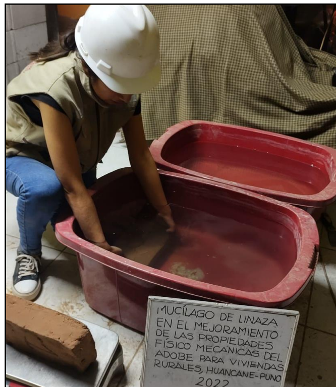
Figura 34: Saturación de unidades de adobe.
