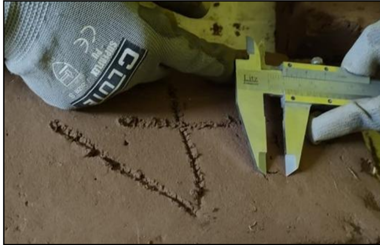
Figura 37: Cuantificación de fisuras adobe tipo 4
