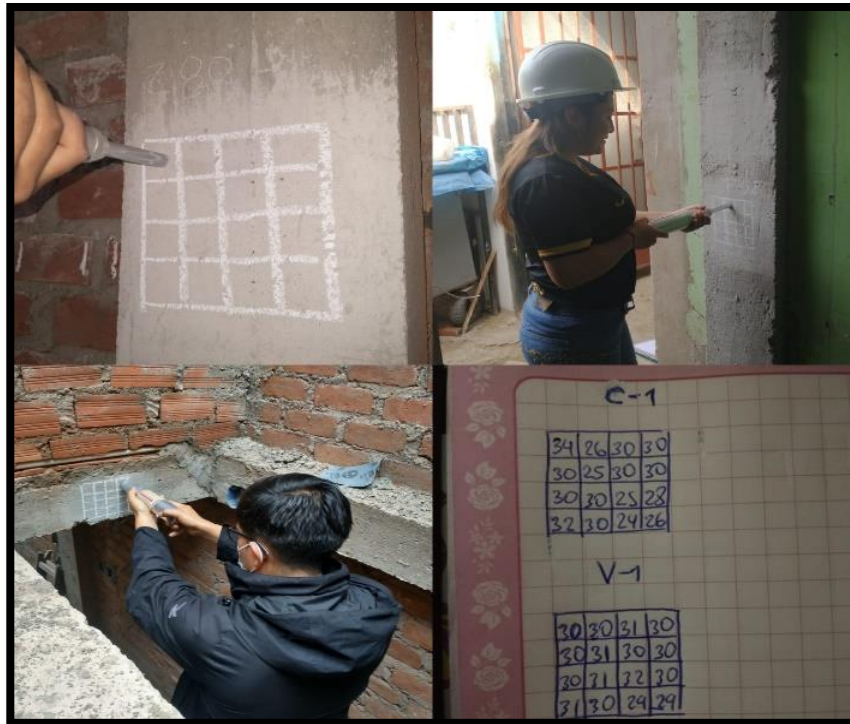
Fig 19. Ensayo con Esclarómetro
