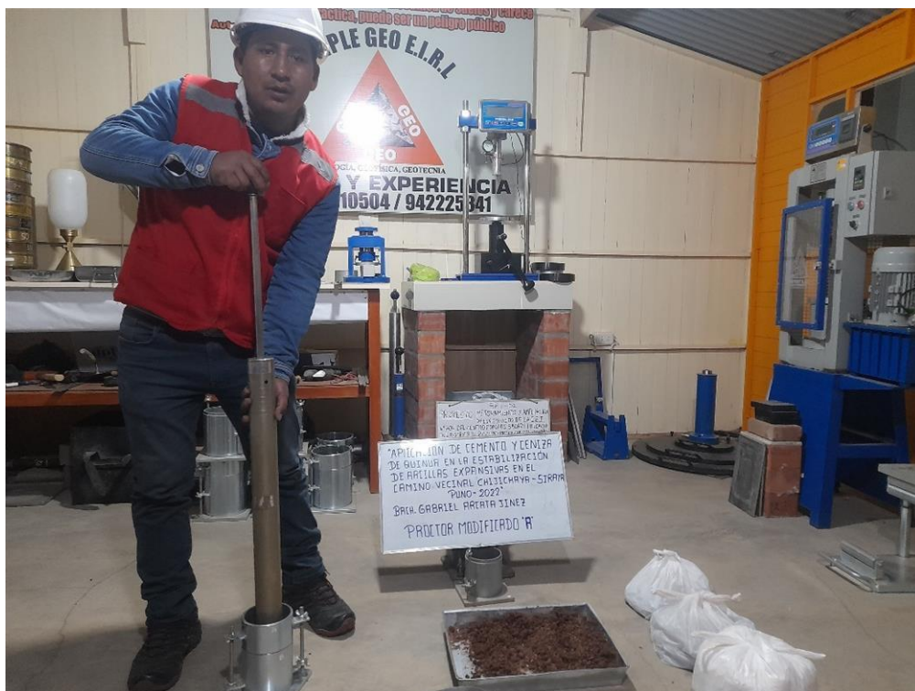
Figura 12. Compactado del espécimen en el molde para el ensayo de Proctor modificado.
