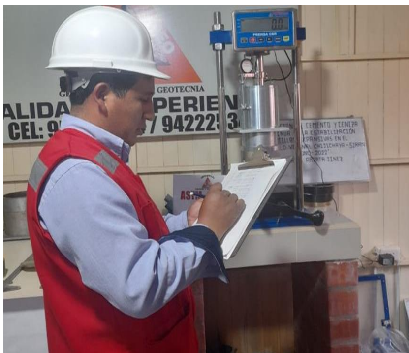
Figura 13. Lectura de la carga aplicada ensayo de CBR.
