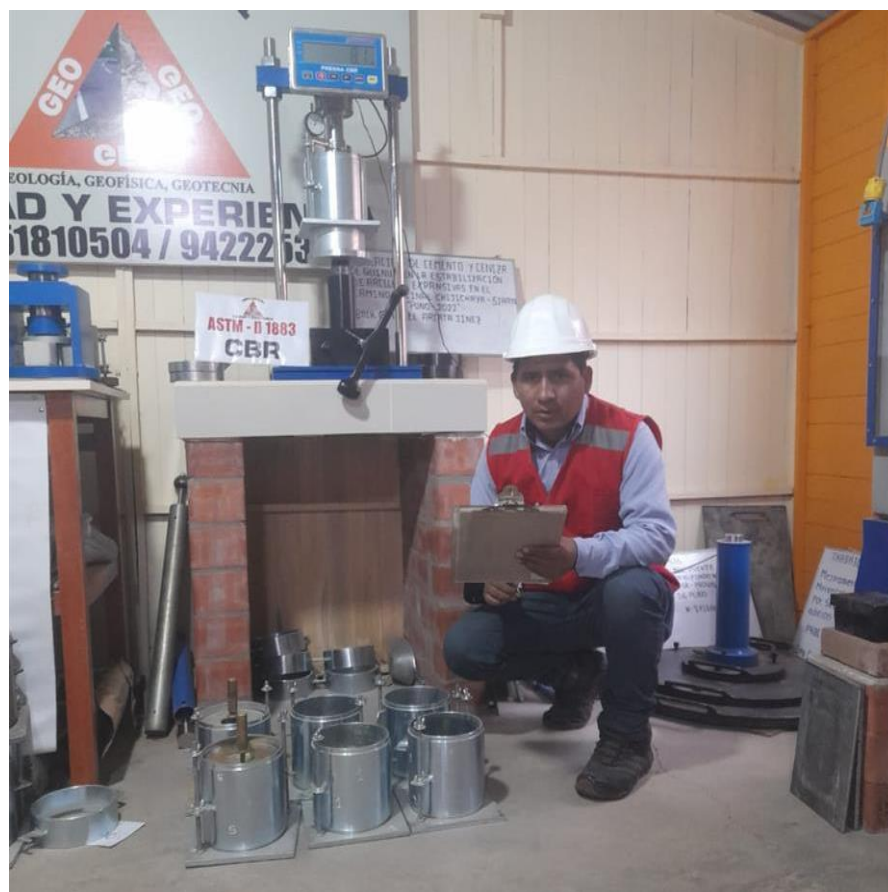
Descripción: compactación en el ensayo de Proctor modificado
