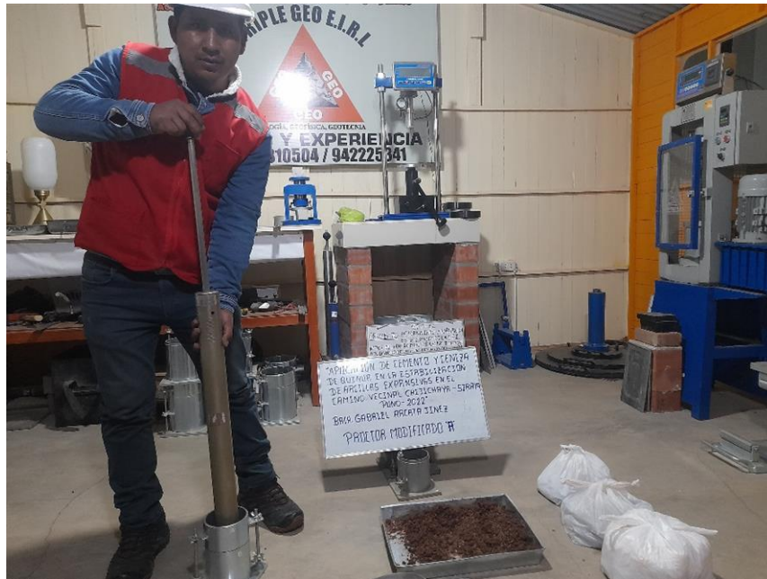
Descripción: compactación en el ensayo de Proctor modificado
