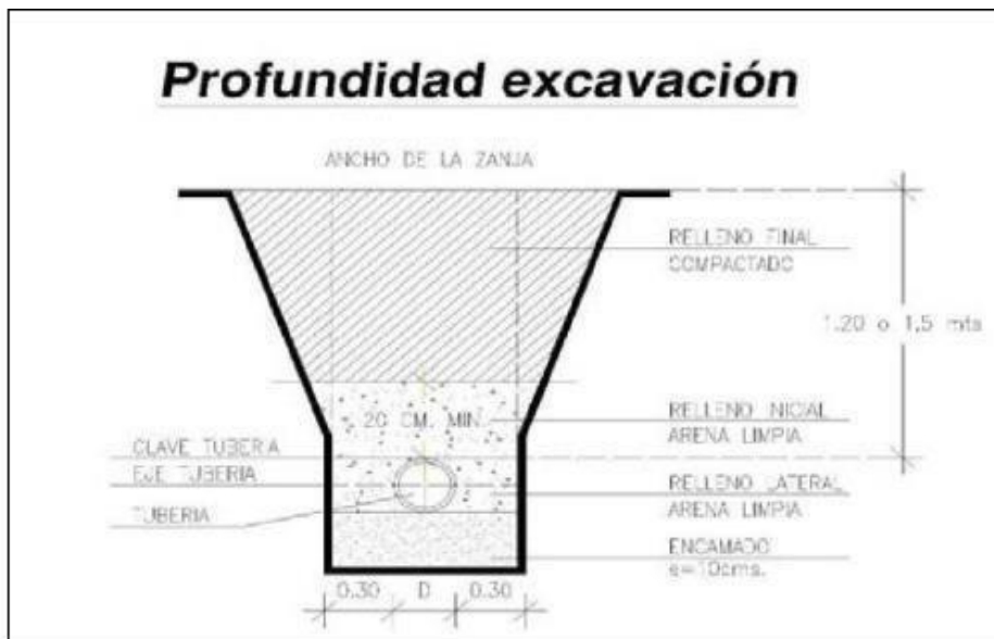
Fig. 22. Detalle de Excavacion para Alcantarillado por gravedad
