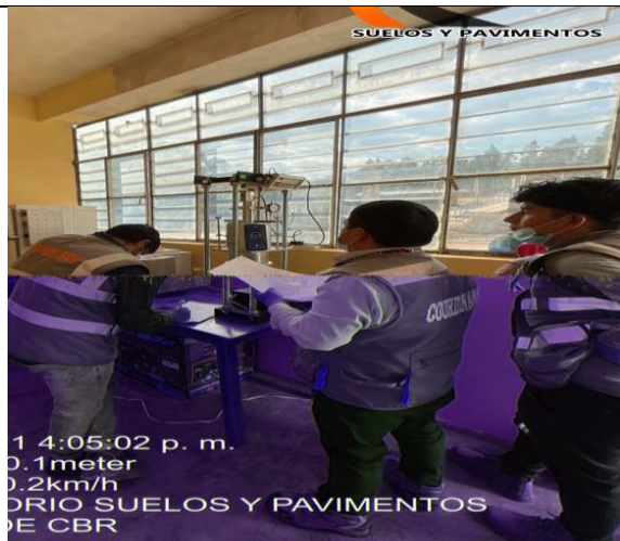
Foto 9: LABORATORIO MECÁNICA DE SUELOS Y PAVIMENTOS (ENSAYO DE CBR, PENETRACION Y TOMA DE LECTURAS)
