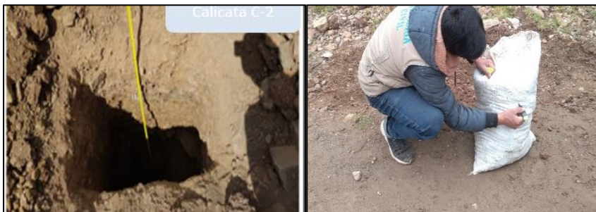
Figura 6. Extracción de muestra para calicata 02.
